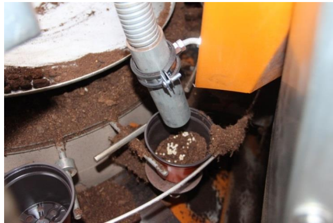
Abbildung 1: Dosierung von Depotdünger mit der „Elevator-Methode“ an der Topfmaschine
