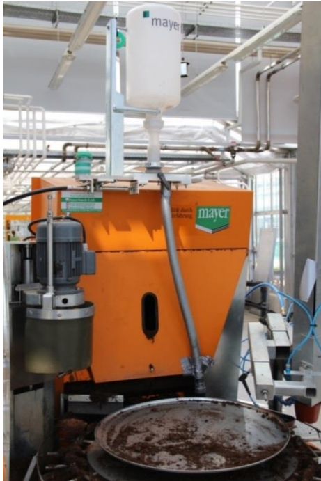
Abbildung 1: Dosierung von Depotdünger mit der „Elevator-Methode“ an der Topfmaschine
