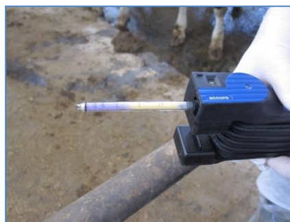
Abbildung 10: Stallklimamessung mit dem Testo ©-Messgerät und Schadgasmessung mit Dräger ©-Röhrchen sowie Handbalgpumpe
