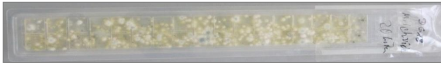
Abbildung 12: RCS®-Agarstreifen zur Bestimmung der Gesamtkeimzahl der Stallluft
