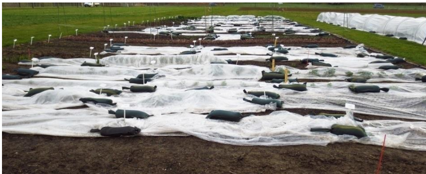
Abbildung 4: Versuchsaufbau 2015 – Flachabdeckungen mit Vlies, Doppelabdeckung mit Vlies/Lochfolie und einfacher Lochfolie
