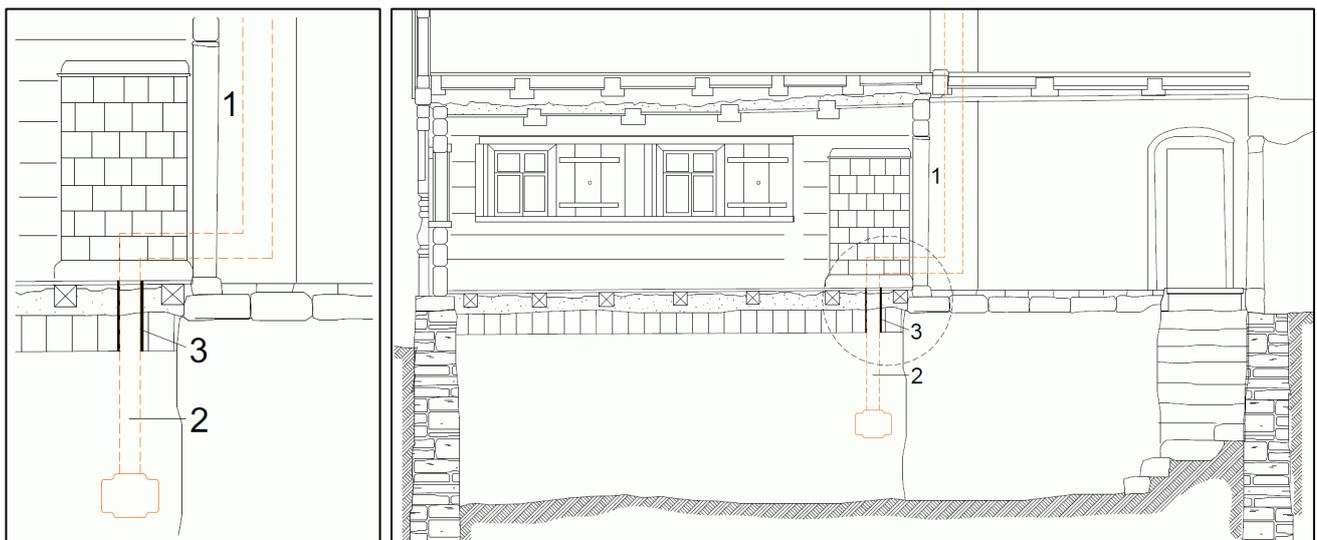
Abb. 99: Anordnung Abluftanlage, Vertikalschnitt
