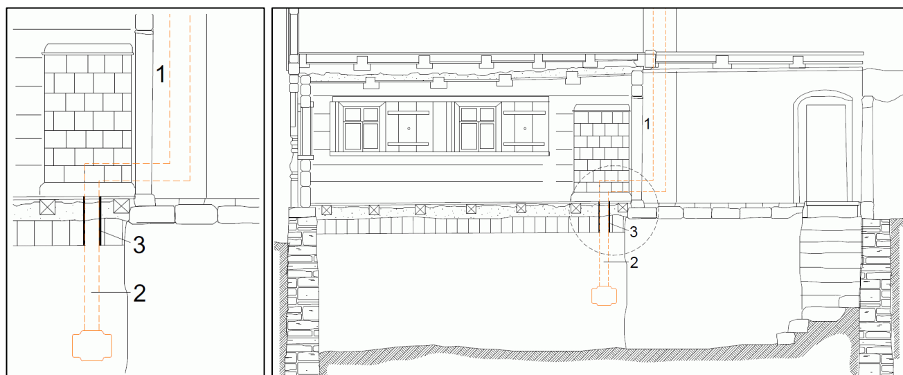
Abb. 99: Anordnung Abluftanlage, Vertikalschnitt
