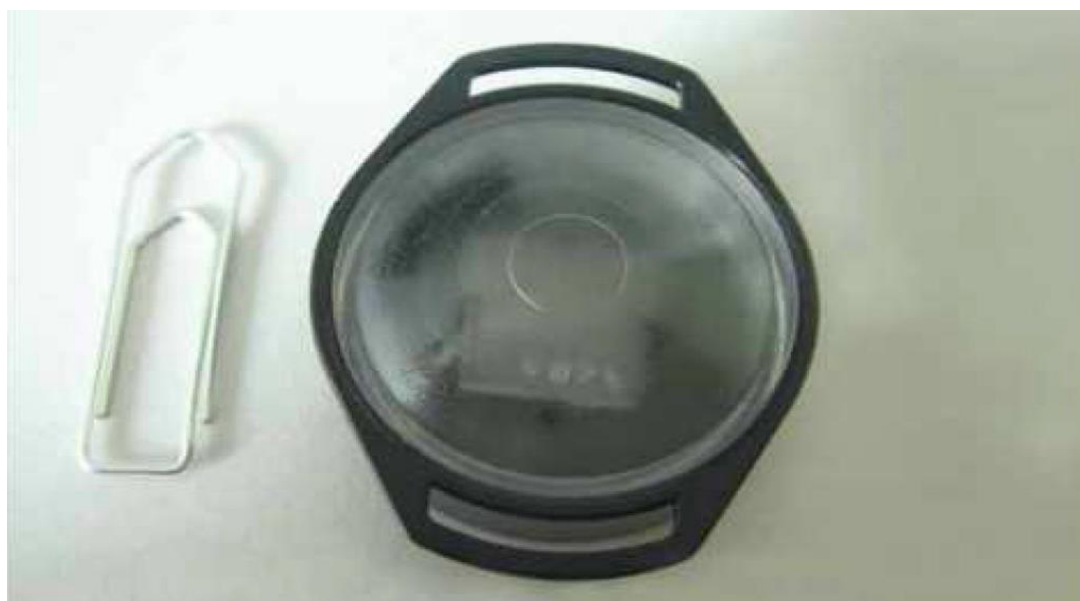
Abb. 7: Kernspurdetektor zur Registrierung von Radon über Zeiträume bis zu einem Jahr [13]
