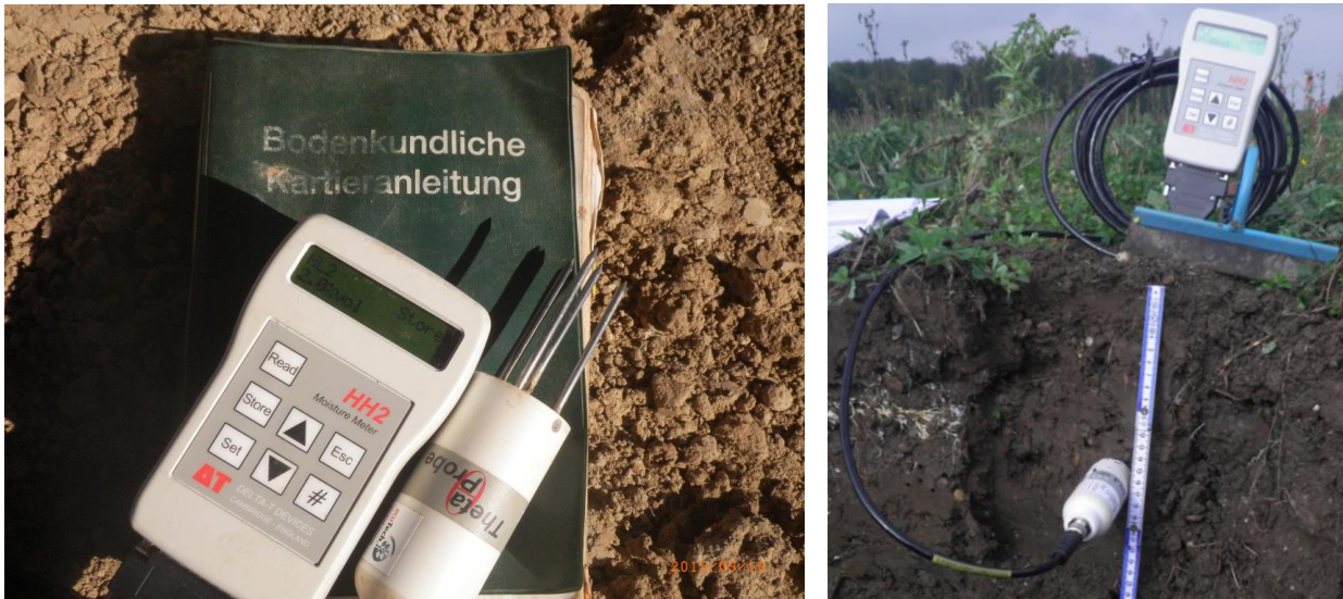
Abbildung 14: Bodenfeuchtemessung mit Hilfe einer TDR-Sonde
