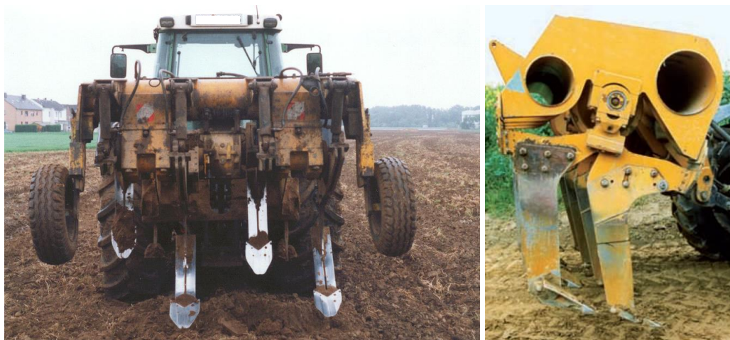
Abbildung 28: Mechanische Tieflockerung; links: Abbruchlockerungsgerät („MM100“; rechts: Stechhublockerer TLG 470 (Foto: T. Weyer, Fachhochschule Südwestfalen)
