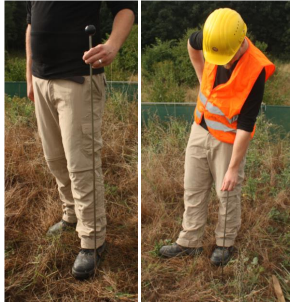
Abbildung 6: Handsonde zur einfachen taktilen Erfassung des Eindringwiderstandes
