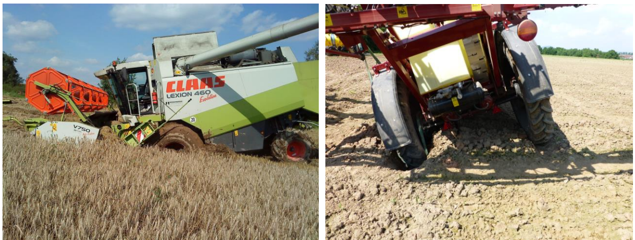
Abbildung 30: Versackte Mähdrescher und Feldspritze nach zu früher Befahrung verfüllter Leitungsräben
