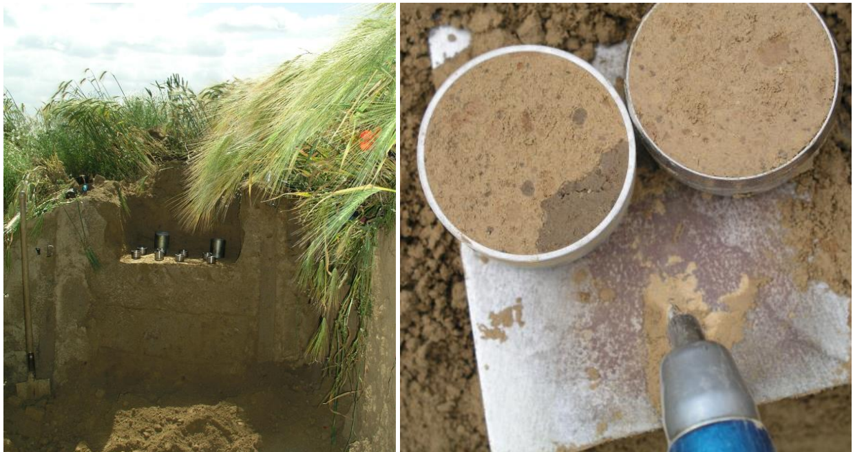
Abbildung 8: Entnahme von ungestörten Bodenproben mit Hilfe von Stechzylindern aus einem Bodenschurf bei der Rekultivierungskontrolle
