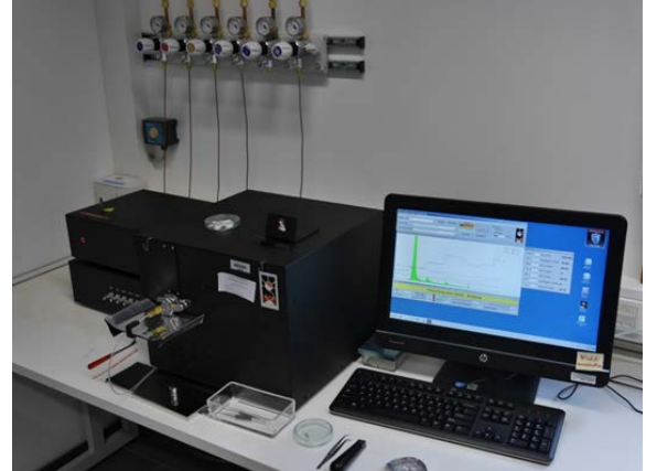
Abb. 7: Analysator zur Bestimmung von organischem, elementarem und gesamten Kohlenstoff im Schwebstaub (Filterprobenahme)
