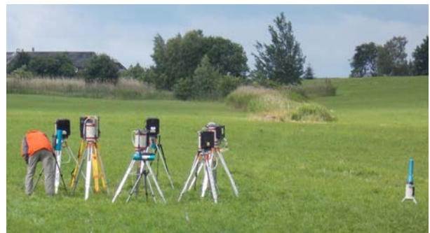
Abbildung 1: In-situ-Gammaskpektrometer bei einer Vergleichsmessung im Raum Zwickau / Seelingstädt
