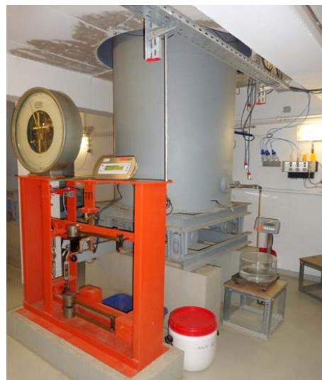
Abb. 11: Einzellysimeter mit Waage und Sickerwasserauslauf im Lysimeterkeller Brandis
