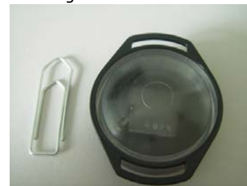
Abb. 10: Beispiel für die aus- zulegenden Dosimeter
