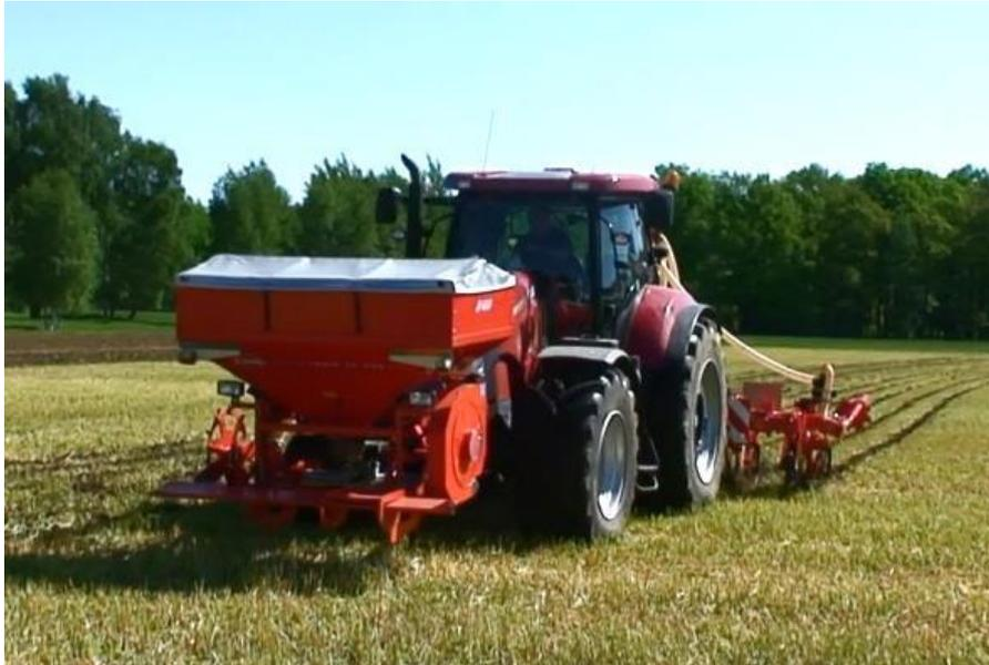
**Abbildung 7: Strip Till mit dem Kuhn Striger und mineralischer Düngung (2013)**
