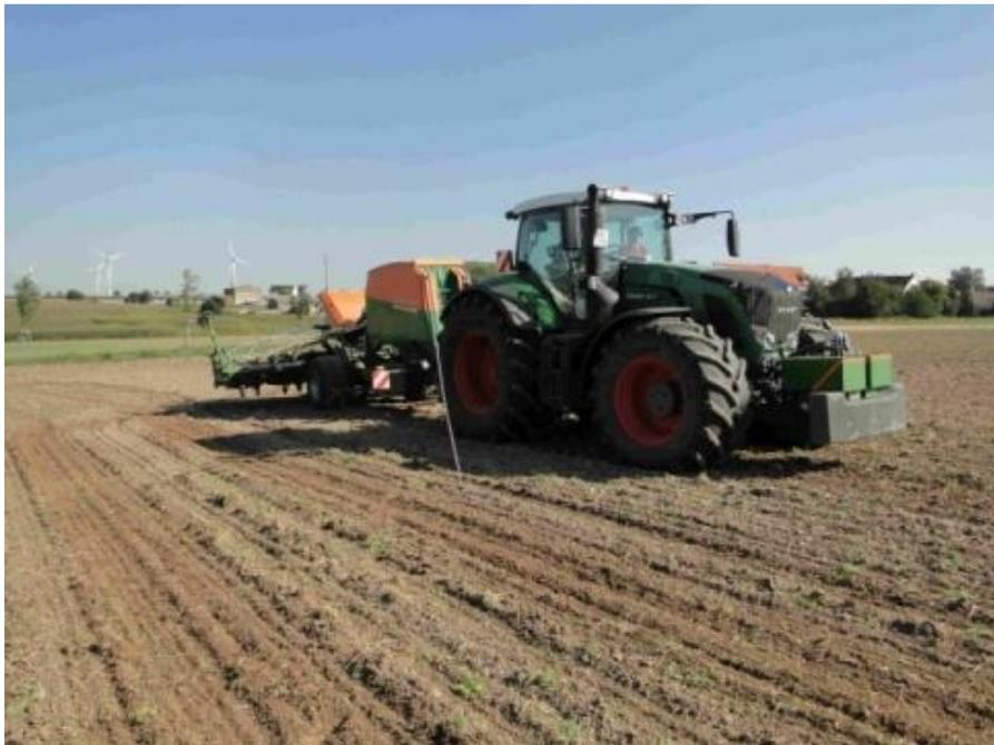
Abbildung 87: Fendt-Traktor mit einer angebauten EDX mit Unterfußdüngung
