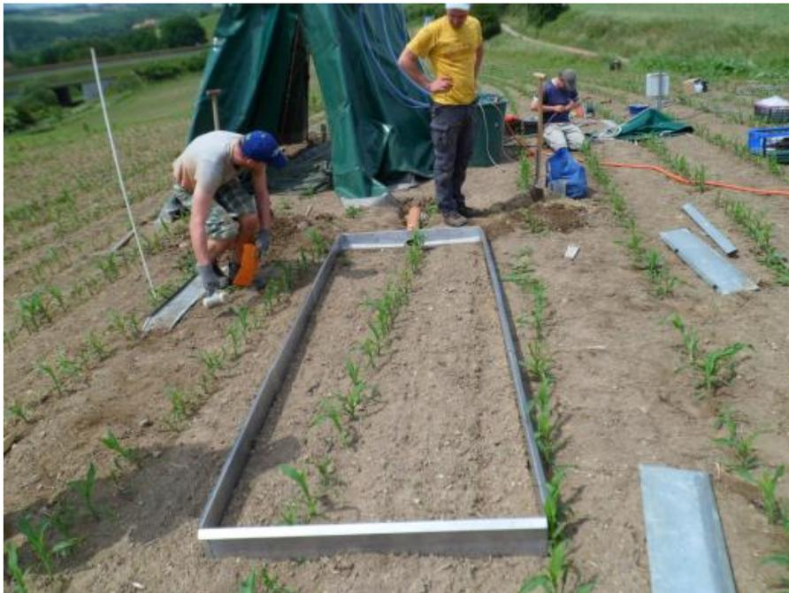
**Abbildung 319: Aufbau der Beregnungsanlage der TU Freiberg Ende Mai 2014 mit 3 m<sup>2</sup> Messfläche in Heidenau auf einem sandigen Lehmboden zu Mais im 6-Blatt-Stadium im Bereich der Mulchsaat**
