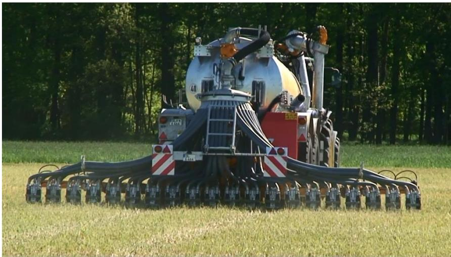
**Abbildung 8: Schlitzverfahren mit einem Scheibeninjektionsgerät (2013)**
