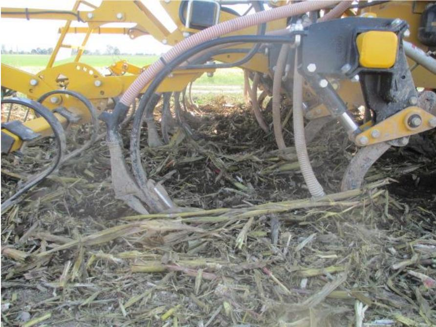
**Abbildung 344: Claydon Hybrid während der Bodenbearbeitung bzw. Aussaat**
