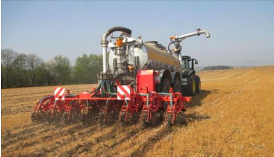
**Abbildung 310: Kuhn Striger angebaut an einem Güllefass der Firma Veenhuis; Reihenlockerung auf 75 cm Abstand; Bearbeitungstiefe ca. 25 cm**
