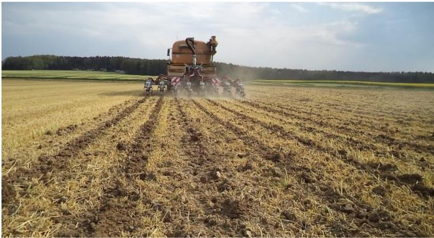
Abbildung 220: TerraGator mit angebautem Streifenbearbeitungsgerät XTill der Firma Vogelsang
