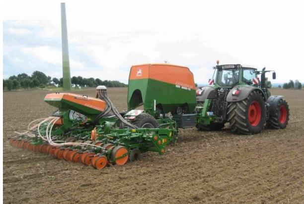
**Abbildung 254: Einzelkornsämaschine Amazone EDX**
