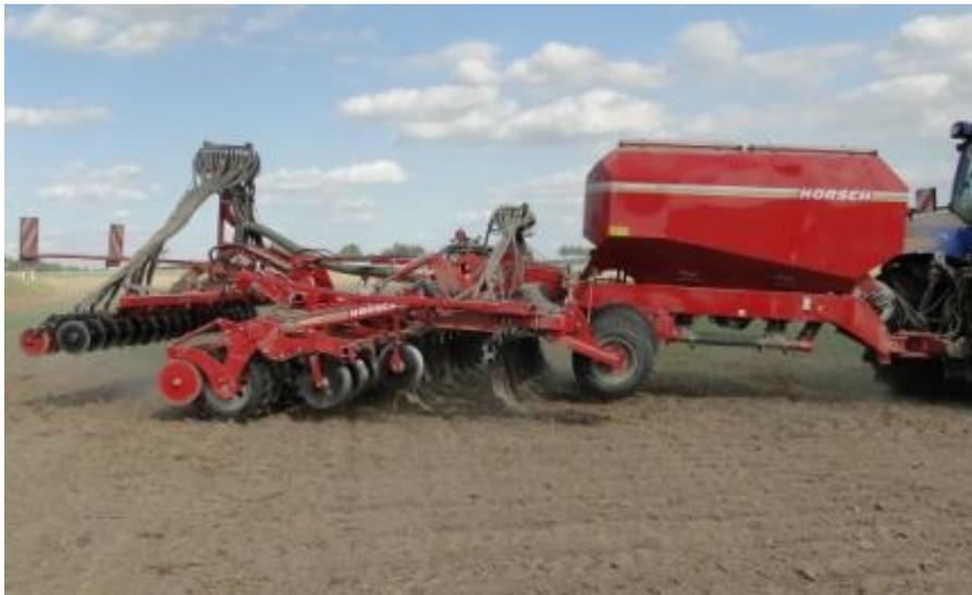
Abbildung 134: Horsch Focus TD für die streifenförmige Grubbersaat – Oschatz 2012
