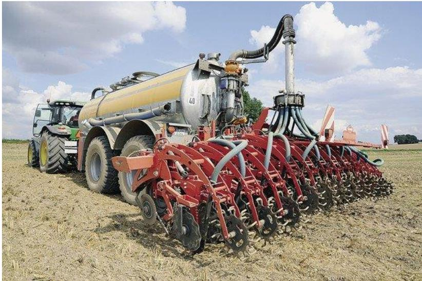
Abbildung 182: Veenhuisgüllefass mit angebautem Kuhn Striger
