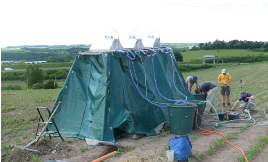
**Abbildung 320: Aufbau der Beregnungsanlage der TU Freiberg Ende Mai 2014 mit 3 m<sup>2</sup> Messfläche in Heidenau auf einem sandigen Lehmboden zu Mais im 6-Blatt-Stadium im Bereich der Mulchsaat**
