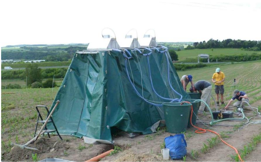
**Abbildung 6: Aufbau der Beregnungsanlage der TU Freiberg Ende Mai 2014 mit 3 m<sup>2</sup> Messfläche in Heidenau auf einem sandigen Lehm Boden zu Mais im 6-Blatt-Stadium im Bereich der Mulchsaat**
