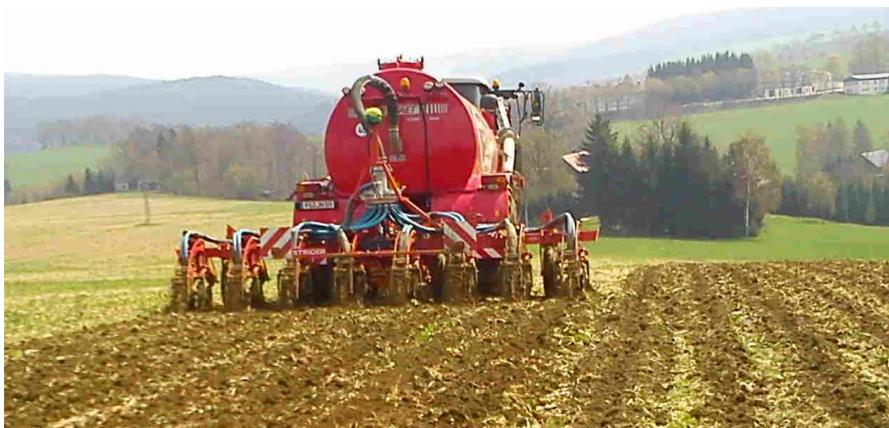
**Abbildung 262: Vervaet Selbstfahrer mit aufgebautem Güllefass und angebautem Kuhn Striger**
