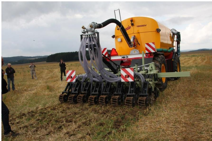
Abbildung 245: Streifenbearbeitung mit dem Maxplacer von Orthman
