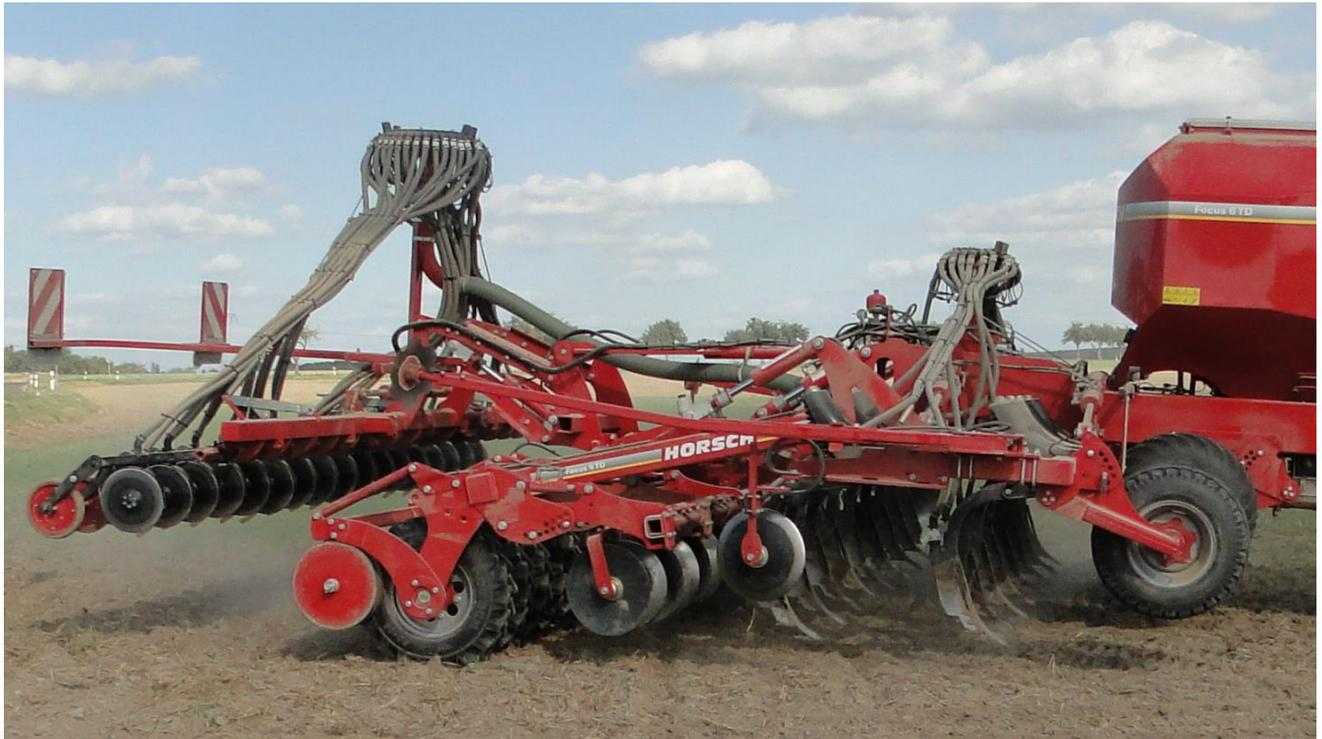
**Abbildung 3: Anordnung der verschiedenen Aggregate im kombinierten Verfahren am Beispiel des HORSCH Focus**
