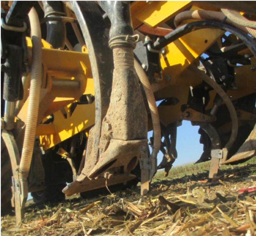
Abbildung 340: Säschare der Claydon Hybrid für die Bandsaat auf 30 cm Reihenabstand
