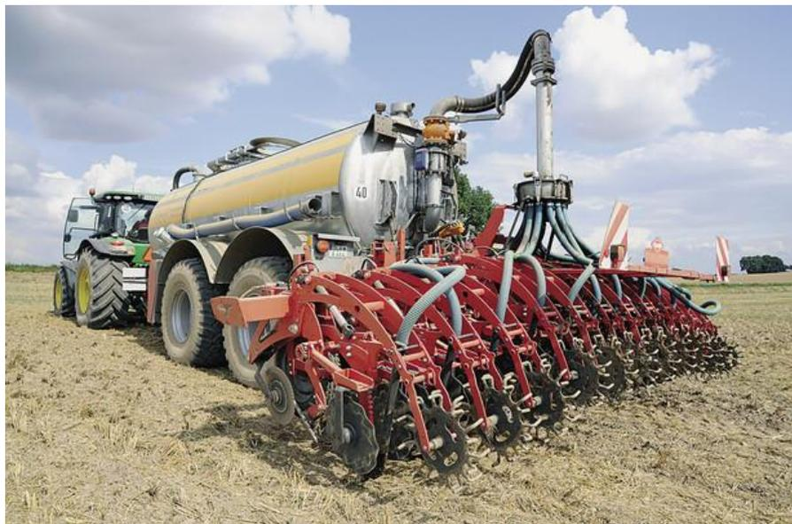
**Abbildung 140: Veenhuisgüllefass mit angebauten Kuhn Striger für die Streifenbearbeitung im absätzigen Verfahren**
