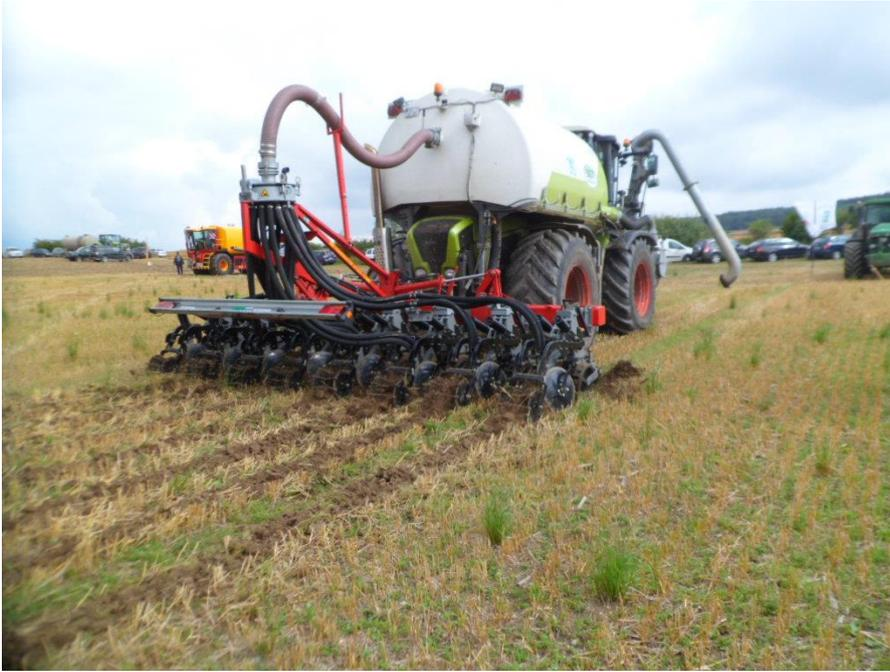
Abbildung 243: Streifenbearbeitung in Elsterberg mit dem Terminator von Duport
