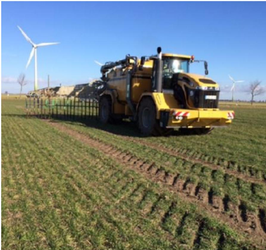
Abbildung 101: TerraGator mit 12m breitem Schleppschlauchgestänge
