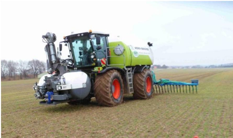
Abbildung 162: Claas Xerion mit RGT Gülleaufbau und 7,60 m breitem Schleppschuhverteiler
