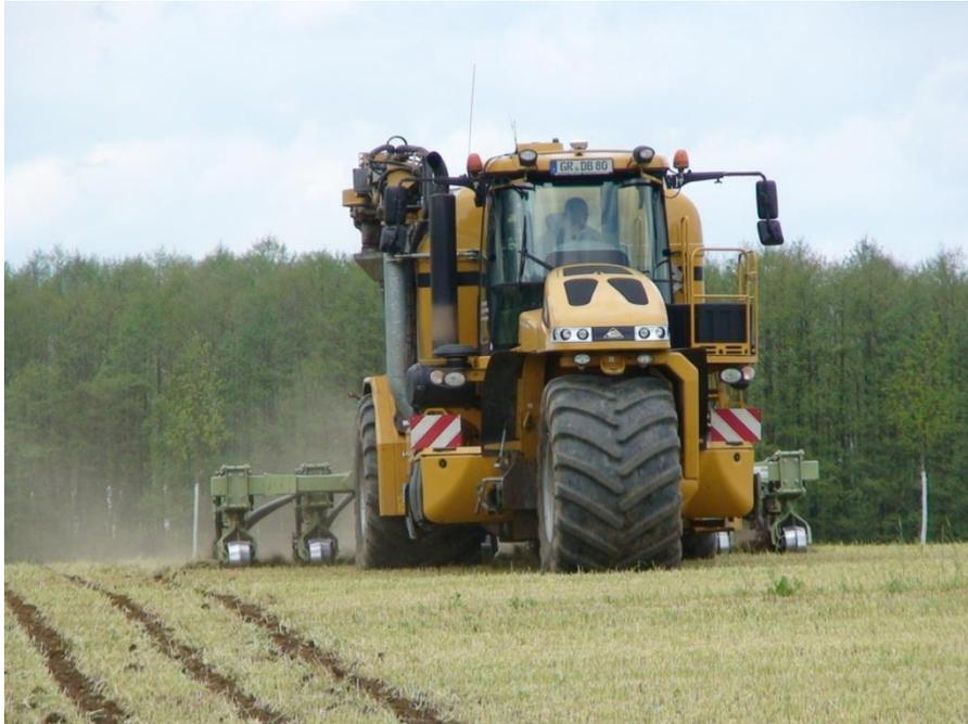
**Abbildung 10: TerraGator mit dem Strip Till-Gerät MAXPLACER der Firma Orthman (2015)**
