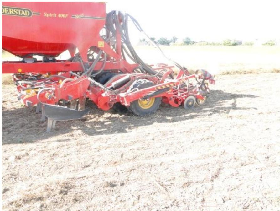
**Abbildung 111: Bodenbearbeitung mit Aussaat und Düngerablage mit der Spirit von Väderstad**
