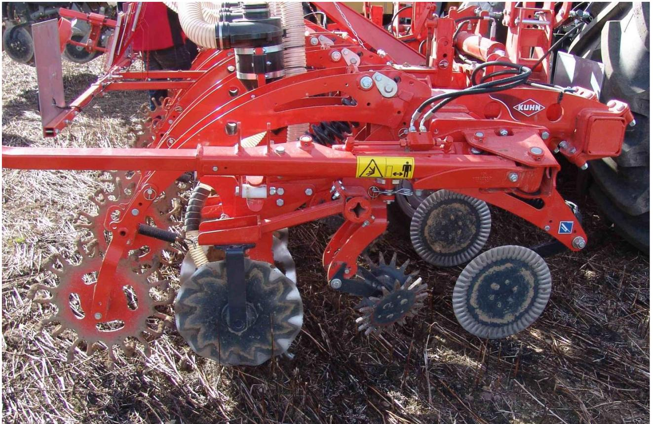
**Abbildung 4: Anordnung der verschiedenen Aggregate bei Streifenbearbeitung im absätzigen Verfahren am Beispiel des Strigers von KUHN**
