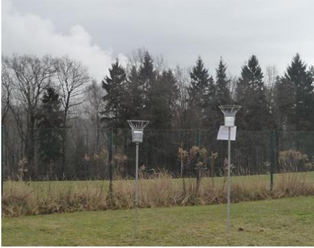
**Abbildung 38: Probenahmegefäß für Staubniederschlagsmessungen (Bergerhoff-Sammler)**
