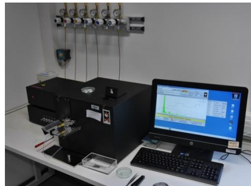
Abb. 31: OCEC-Analysator zur Bestimmung von organischem, elementarem und gesamten Kohlenstoff im Schwebstaub (Filterprobenahme)
