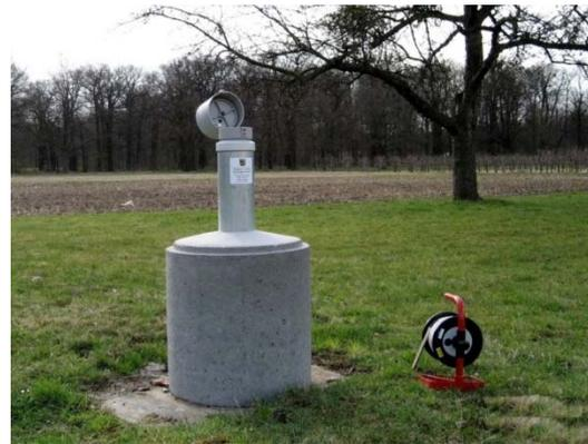
Abb. 10: Neu errichtete Grundwassermessstelle
