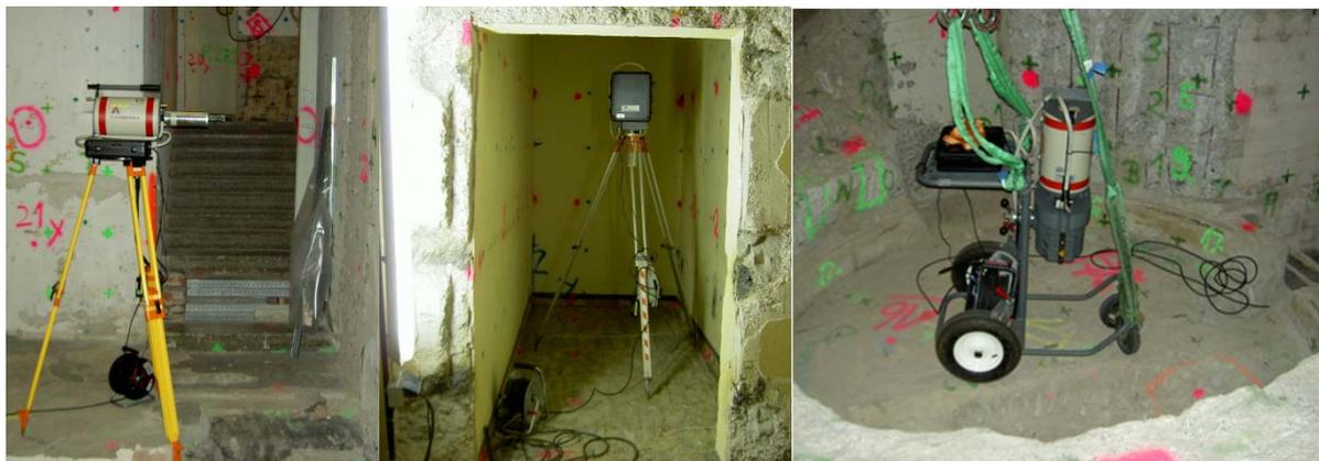
Abb. 7: Unkollimierte Messung mit Blick auf die Wand (links) und mit Blick auf den Boden (Mitte). Kollimierte Messung mit Blick auf den Boden der Reaktorkrypta (rechts).
