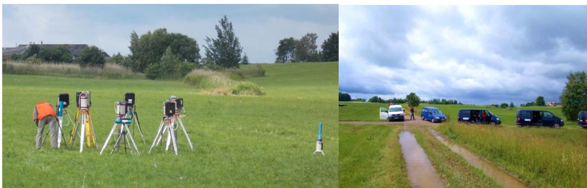
Abb. 4: In-situ-Gammaspektrometer (links) und Messfahrzeuge (rechts) bei einer Vergleichsmessung im Raum Zwickau / Seelingstädt.
