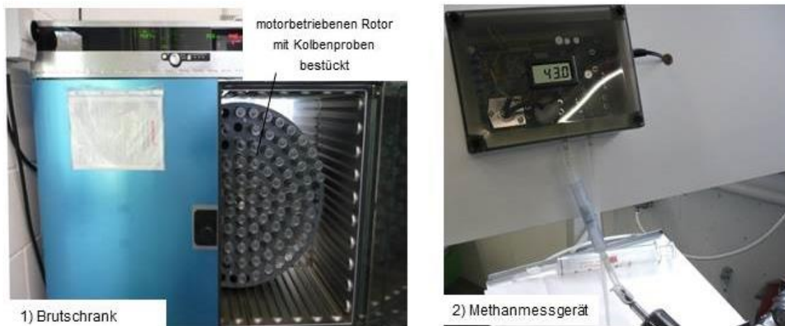
Abbildung 4: Aufbau der Biogasanlage Hohenheimer Biogasertragstest (HBT)
