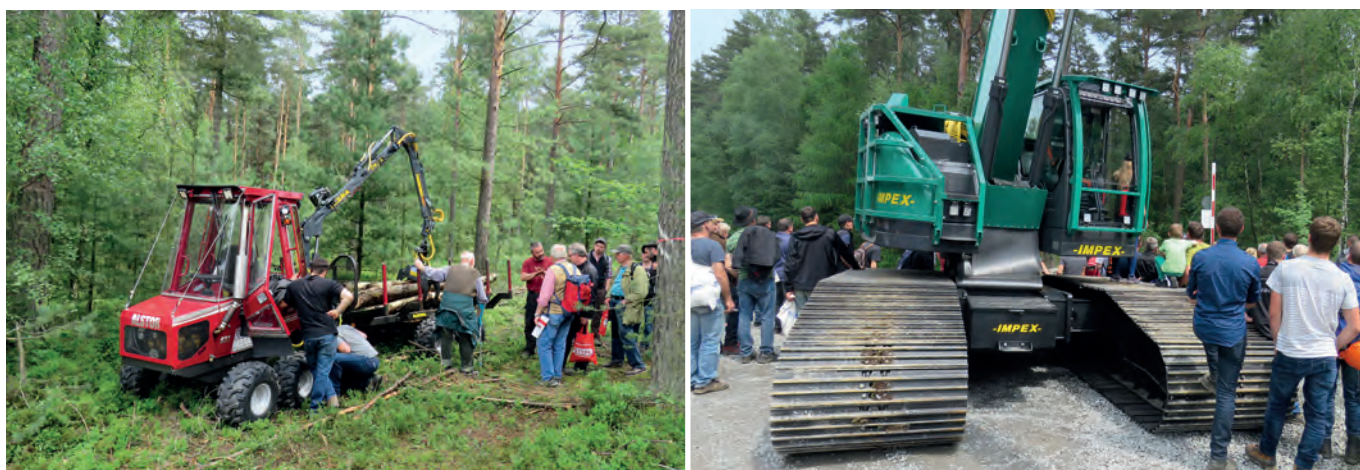
Abb. 3 und 4: Kleine und große Forsttechnik für (fast) alle Einsatzbereiche: Miniforwarder (links) und Raupenharvester (rechts), Fotos: H. Ullrich
