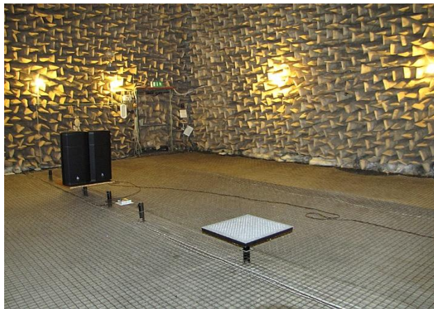
Abbildung 16: Vermessung der Lautsprecher im Großen Reflexionsarmen Raum der TU Dresden
