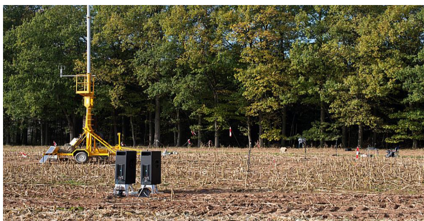
Abbildung 18: Sendeseitige Messstrecke mit Lautsprecheraufstellung
