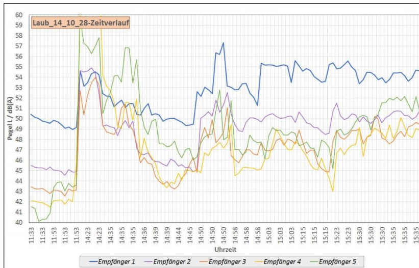
Abbildung 5: Zeitlicher Verlauf der A-bewerteten Empfangspegel am 28.10.2014/Laubwald
