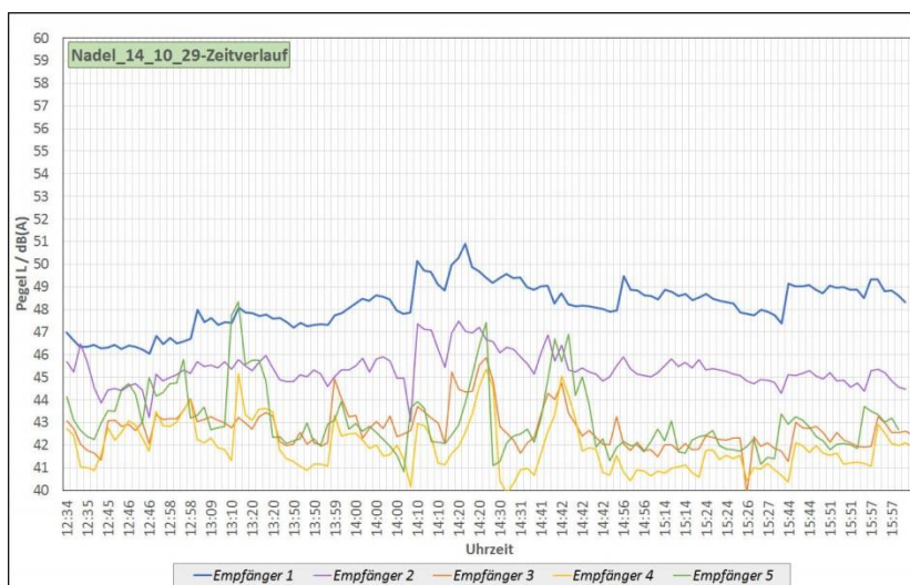
Abbildung 6: Zeitlicher Verlauf der A-bewerteten Empfangspegel am 29.10.2014/Nadelwald
