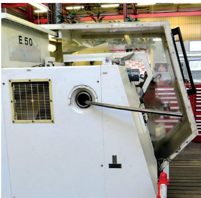
Abb. 1: Abgewinkeltes Material nach dem Unfallereignis, Foto: Firmenfoto
