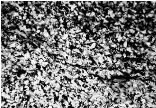
Abb. 2-5: Quarzit im mikroskopischen Bild; Rebesgrün, Schacht 404, +328 m-Sohle, Strecke Süd bei 230 m; Bildbreite 4 mm
