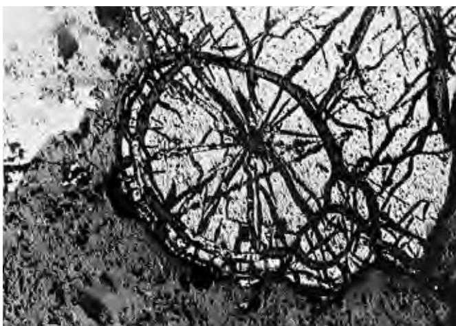
Abb. 3-24: Pechblende in Karbonatmatrix mit Chalkopyrit und Quarzeinschlüssen; Zobes, -83 m-Sohle, Querschlag 509, Strecke 31082; Bildbreite 1 mm
