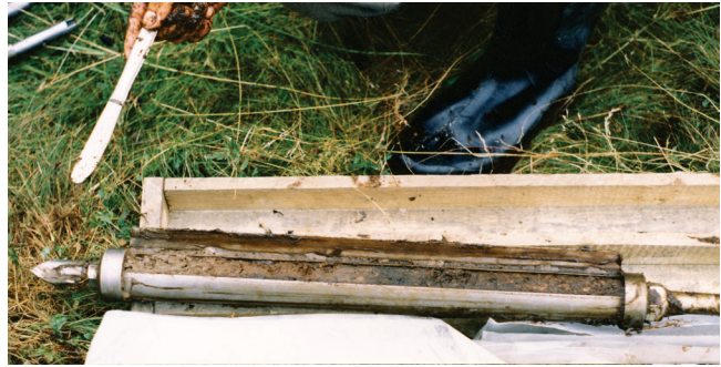
Abb. 19: Probenahme 1994, Bohrsonde mit unterster Probe im Übergang zum Gesteinszersatz aus dem Moor Lehmheide. Foto: K.-H. Thuß, LfULG
