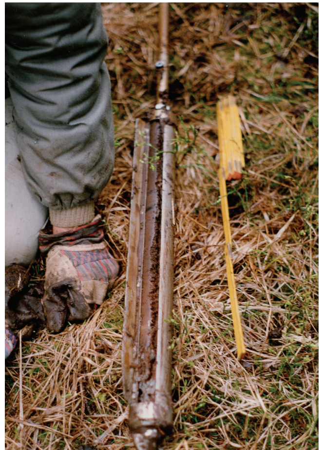
Abb. 3: Bohrarbeiten mit dem Kammerbohrer nach Hiller am Pfahlbergmoor.
