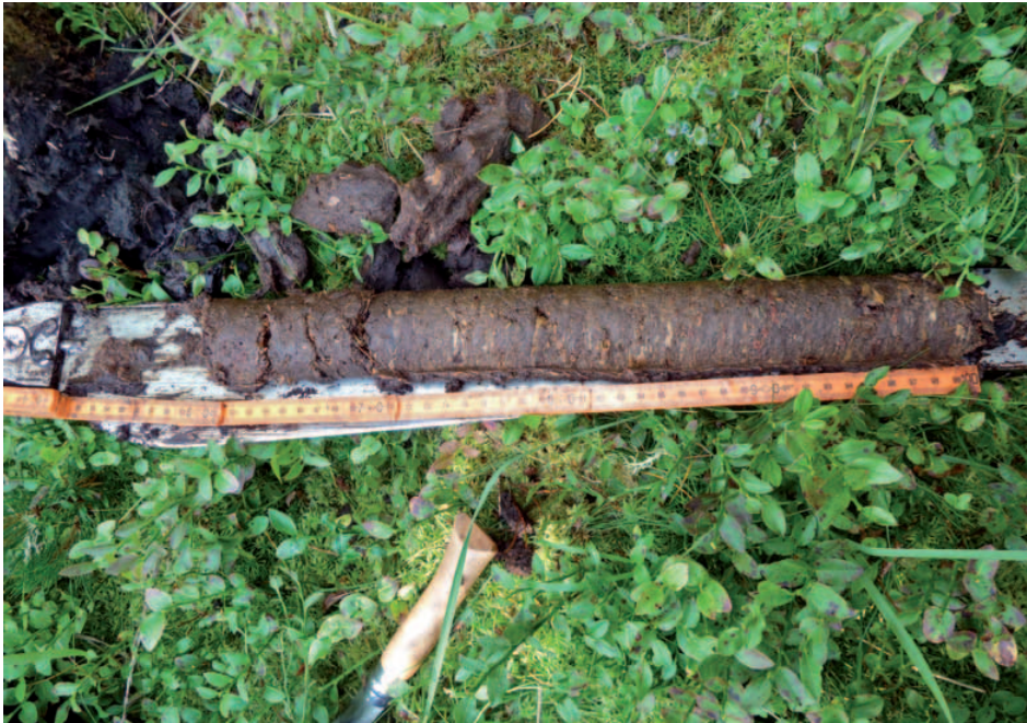
Abb. 2: Bohrkern mit Schilftorf im Flöbner Moor bei Satzung (Mittleres Erzgebirge) Foto: K. Keßler (2013)
