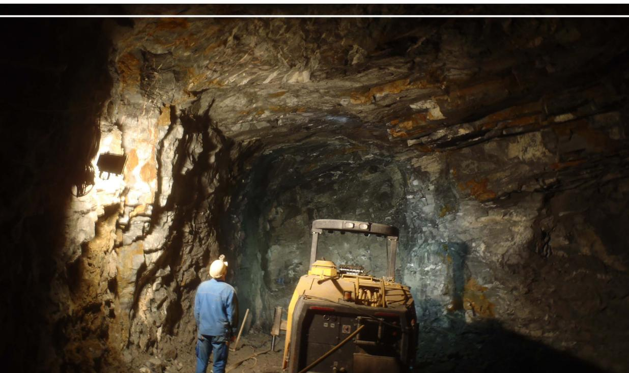
Foto 6.4: Flussspatgrube Niederschlag – Vortriebsbohrwagen Atlas Copco S1D (Erzgebirgische Fluss- und Schwerspatwerke GmbH, H. Ehle)
