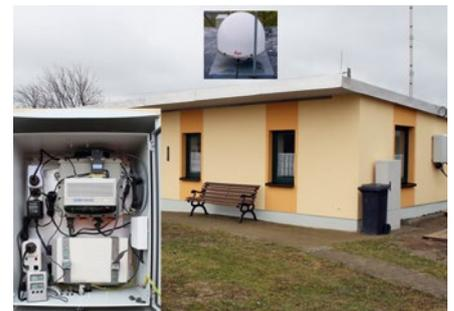
**Abb. 32:** GPS-Station Neustadt, die GPS-Antenne (siehe Vergrößerung) befindet sich mittig auf dem Flachdach, links unten: Innenansicht des Geräteschranks
