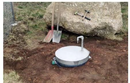
**Abb. 28:** Verschlüssener Seismometerschacht: Der Seismometerschacht schließt knapp über dem Gelände mit einem verschlossenen Edelstahldeckel ab; das winklige Rohr dient der Be- und Entlüftung. Das Registriergerät steht im Wetterhäuschen links hinter dem Maschendrahtzaun, die Kabelverbindungen wurden unterirdisch verlegt. Quelle: Klaus Weißenfels
