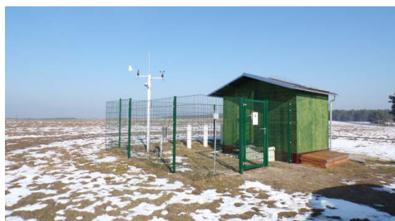
Abb. 5: neue Station Lippen mit Gerätehaus, Klimastation und Bulk-Sammlern.
