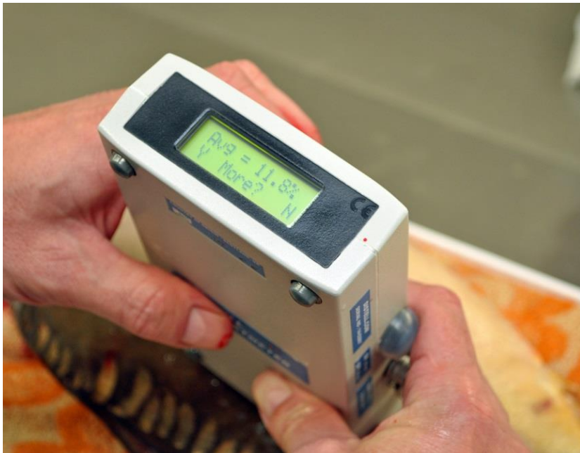
Abbildung 16: Filetfettmessung mit DISTELL®-Fish-Fatmeter
