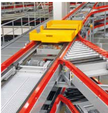
LACS-Förderanlage mit Transportschale
