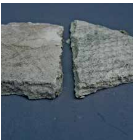
Linke Probe asbestfrei, rechte Probe asbesthaltig (Baufatherm) (Asbestprobensammlung LDS)
