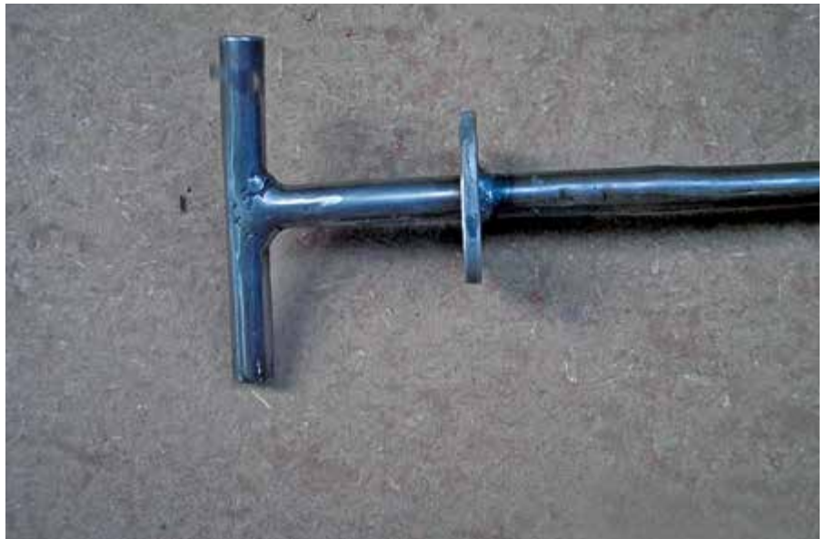
Die an die Stange nachträglich angeschweißte Sicherungsplatte verhindert zuverlässig, dass die den Haltegriff umfassenden Finger auf das Gitterrost gezogen werden, wenn bei Einzug der Stange der Haltegriff nicht losgelassen wird.
