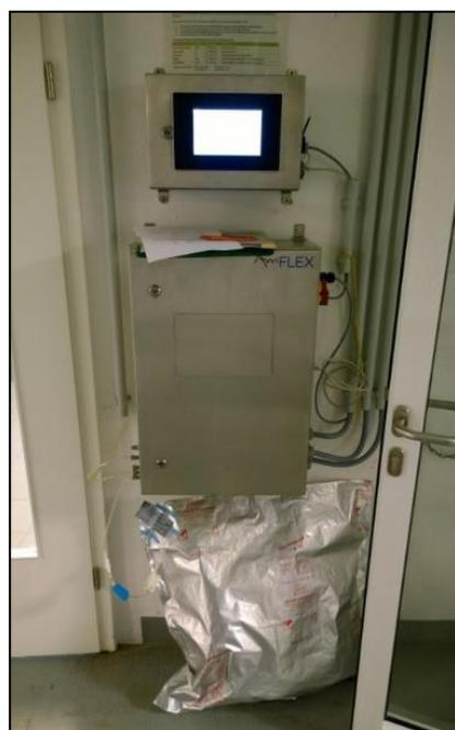
**Abbildung 7: Stationäre Biogasanalyse Awi Flex Serie 7**
