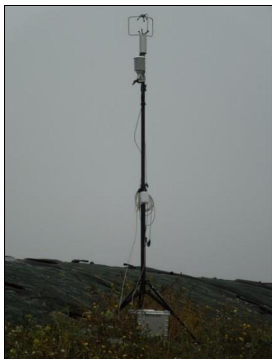
**Abbildung 8: Stationäre Wetterstation**
