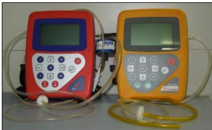
**Abbildung 6: Am DBFZ verfügbare Biogasmonitore (links BM 2000)**
