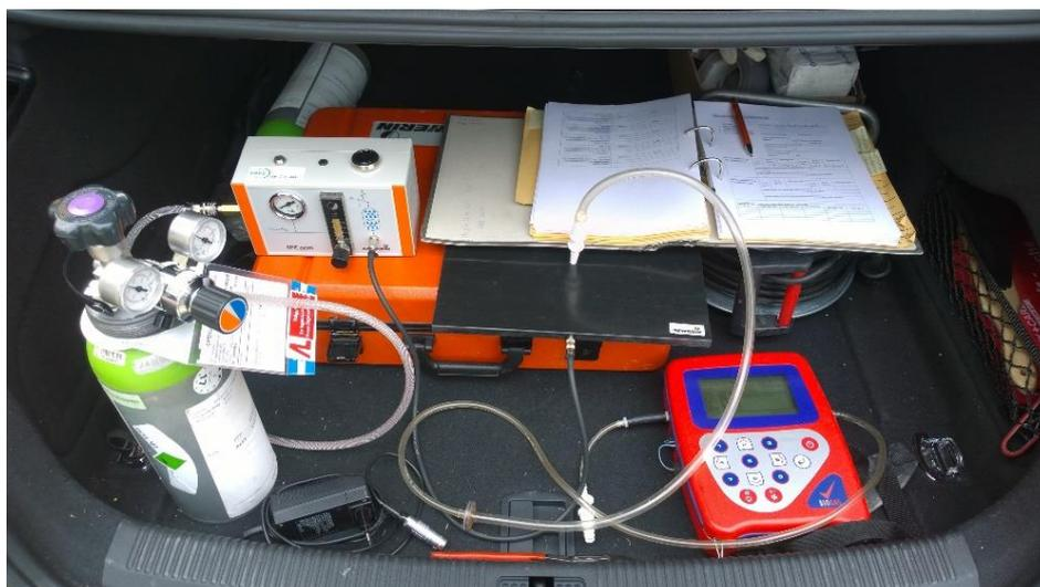
**Abbildung 9: Vor-Ort-Kalibrierung des verwendeten Biogasmonitors (vgl. Kapitel 4.2.1)**
