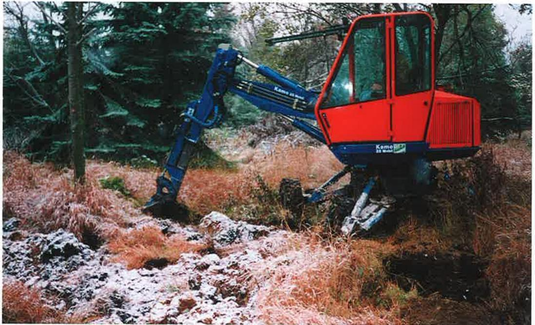
Durch den Pflanzhügel wird die Jungpflanze aus der Verdämmungs- und Frostzone herausgehoben, der verdichtete und unter Luftabschluss liegende Mineralboden wird durchmischt und entwässert. Der Zeitaufwand ist relativ hoch, außerdem ist die Fläche nach der Bearbeitung schwer begehbar. Die zurückgelassenen Löcher (Material für etwa 6 Hügel) üben zwar auf ihre unmittelbare Umgebung eine gewisse Dränagewirkung aus, sie erhöhen jedoch bei den Nachfolgearbeiten die Unfallgefahr beträchtlich.
