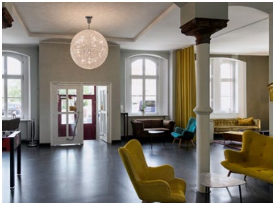
Die Säulen in der Eingangshalle waren zugemauert. Sie wurden beim Umbau entdeckt und freigelegt.
