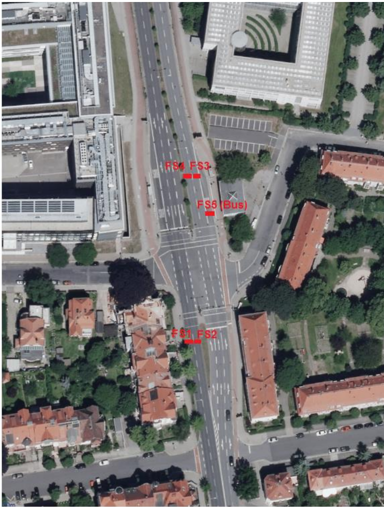
Abbildung 5: Luftbild mit eingetragenen Messpunkten der Pegelzählstelle PZS0507 der Stadt Dresden in Höhe Mommsenstraße (Luftbild: © Staatsbetrieb Geobasisinformation und Vermessung Sachsen, http://www.geosn.de )
