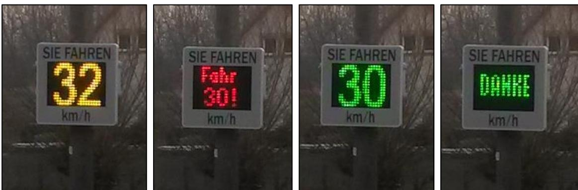
**Abbildung 1: Anzeigebispiele Geschwindigkeitsanzeigetafel / Dialog-Display**
