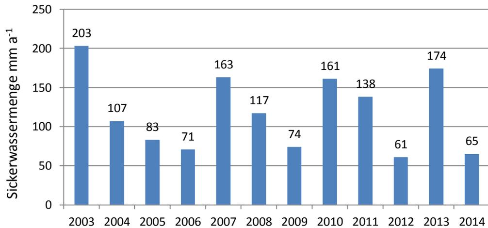
**Abbildung 2:** Jahreswerte der Sickerwassermenge der Pelosol-Schwarzerde aus Tonmergeln des mittleren Keupers im Thüringer Becken mit ackerbaulicher Nutzung, berechnet mit dem Verdunstungsmodell VERD
