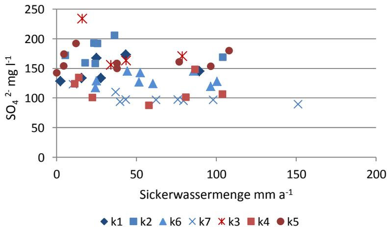
**Abbildung 21:** Zusammenhang zwischen den Jahresdurchschnittswerten der SO<sub>4</sub>-Konzentration des Sickerwassers und der Sickerwassermenge der Einzellysimeter auf der Para-Rendzina aus unterem Keuper im Untersuchungszeitraum von 2005 bis 2014 (mineralisch: k1, k2, k6 und k7 (blau), mineralisch-organisch: k3, k4 und k5 (rot))
