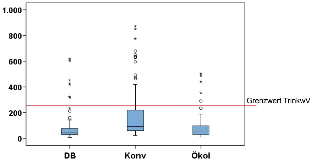
**Abbildung 11:** Sulfat(SO<sub>4</sub>)-Konzentrationen im Sickerwasser der Bewirtschaftungsvarianten Dauerbrache (DB), konventioneller (Konv) und ökologischer (Ökol) Landbau im Untersuchungszeitraum (Median, Min, Max, 25-, 75 % Quantil und Ausreißer, n=102 (DB), n=121 (Konv), n=118 (Ökol))
