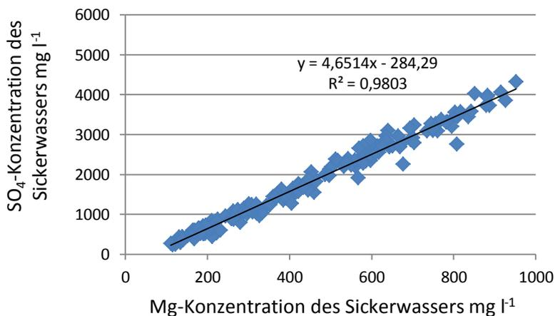
**Anlage 5:** Zusammenhang zwischen der SO<sub>4</sub>- und Mg-Konzentration des Sickerwassers
