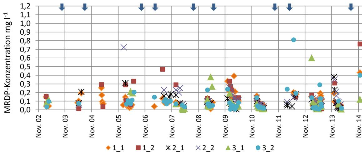
**Anlage 2:** MRDP-Konzentration des Sickerwassers der Pelosol-Schwarzerde aus Tonmergeln des Keupers im Thüringer Becken im zeitlichen Verlauf von 2003 bis 2014, blauer Pfeil...Gülleapplikation, 20 bis 70 m<sup>3</sup>/ha und damit 10 bis 23 kg P/ha
