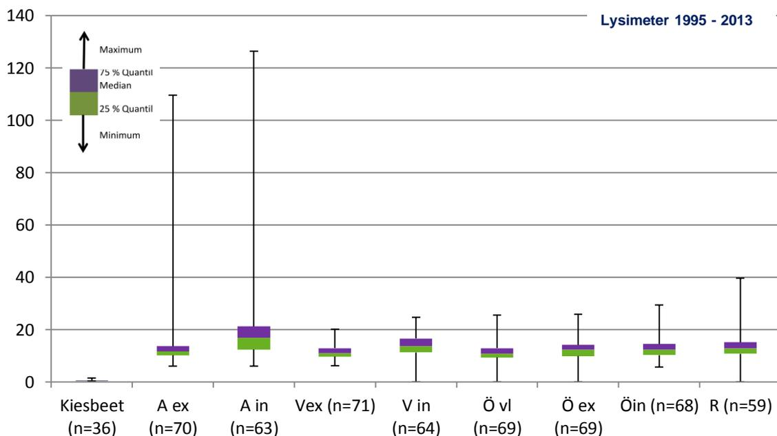
**Abbildung 11:** Rückgerechnete mittlere Mg-Konzentration (mg/l) im Sickerwasser aller Bewirtschaftungsvarianten nach 18 Versuchsjahren
