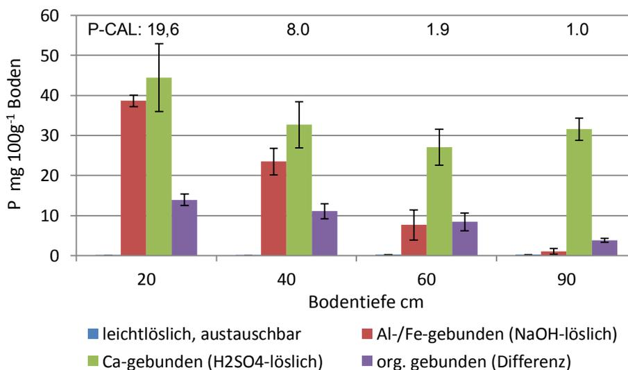
**Abbildung 6:** Anteile unterschiedlicher P-Fractionen des Bodens am P-Gesamt-Gehalt (sequentielle P-Fraktionierung nach Kurmies),
