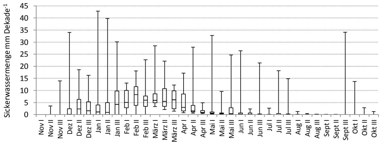
**Anlage 1:** Boxplot-Auswertung der Dekadenwerte der berechneten Sickerwassermengen im Mittel der Jahre 2004 bis 2014 auf der Pelosol-Schwarzerde aus Tonmergeln des Keupers im Thüringer Becken
