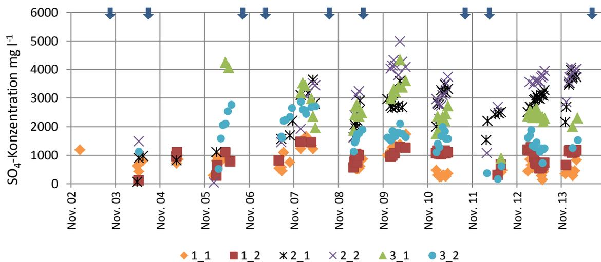
**Abbildung 13:**  $\text{SO}_4$ -Konzentration des Sickerwassers der Pelosol-Schwarzerde aus Tonmergeln des mittleren Keupers im Thüringer Becken im zeitlichen Verlauf von 2003 bis 2014, blauer Pfeil...Gülleapplikation
