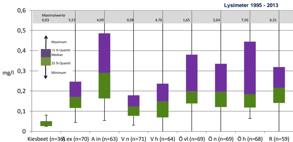
**Abbildung 3:** Rückgerechnete mittlere P-Konzentration (mg/l) im Sickerwasser aller Bewirtschaftungsvarianten nach 18 Versuchsjahren
