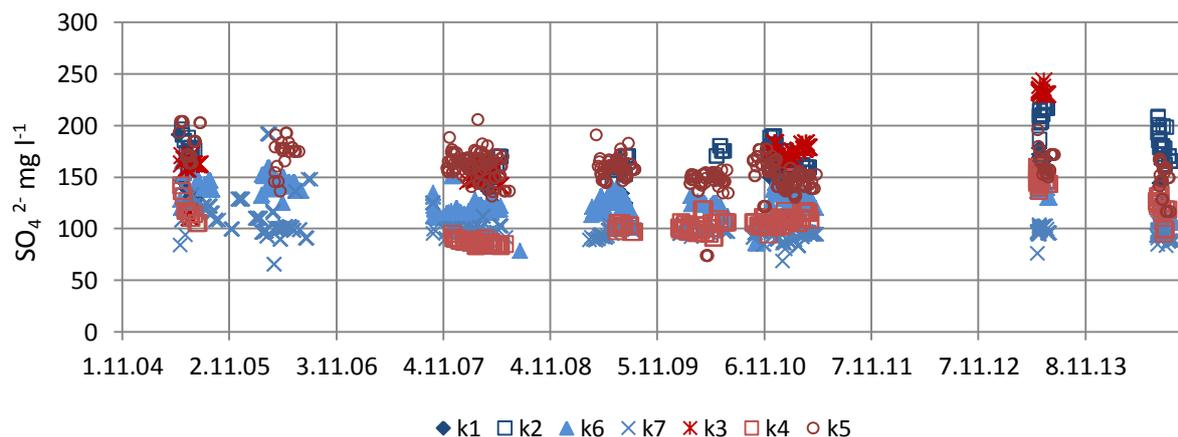
**Abbildung 20:** Verlauf der  $\text{SO}_4$ -Konzentration des Sickerwassers der Para-Rendzina aus unterem Keuper von 2005 bis 2014 bei mineralischer (k1, k2, k6 und k7) und mineralisch-organischer Düngung (k3, k4 und k5)
