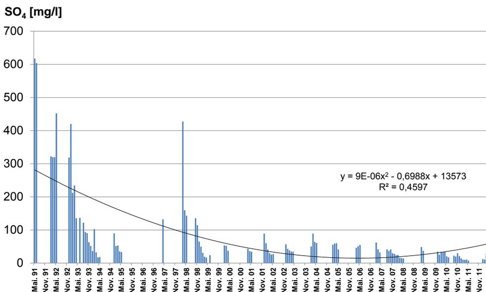
**Abbildung 12:** Zeitlicher Verlauf der Sulfat(SO<sub>4</sub>)-Konzentrationen im Sickerwasser unter Dauerbrache
