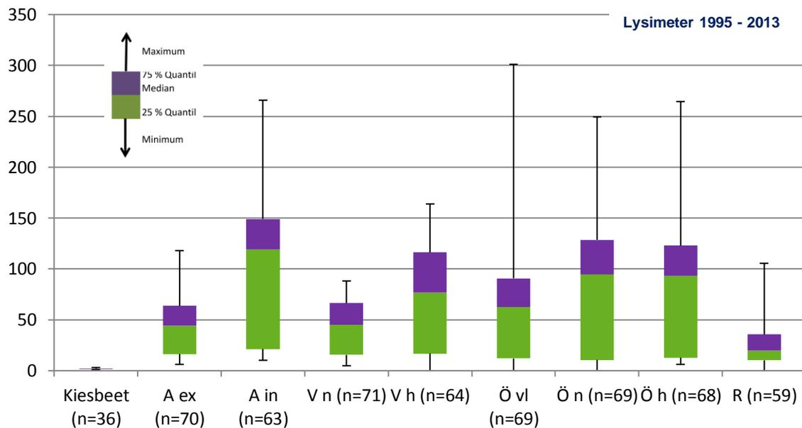
**Abbildung 14:** Rückgerechnete mittlere SO<sub>4</sub>-Konzentration (mg/l) im Sickerwasser aller Bewirtschaftungsvarianten nach 18 Versuchsjahren
