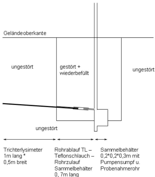
**Abbildung 1:** Darstellung einer Trichterlysometeranlage
