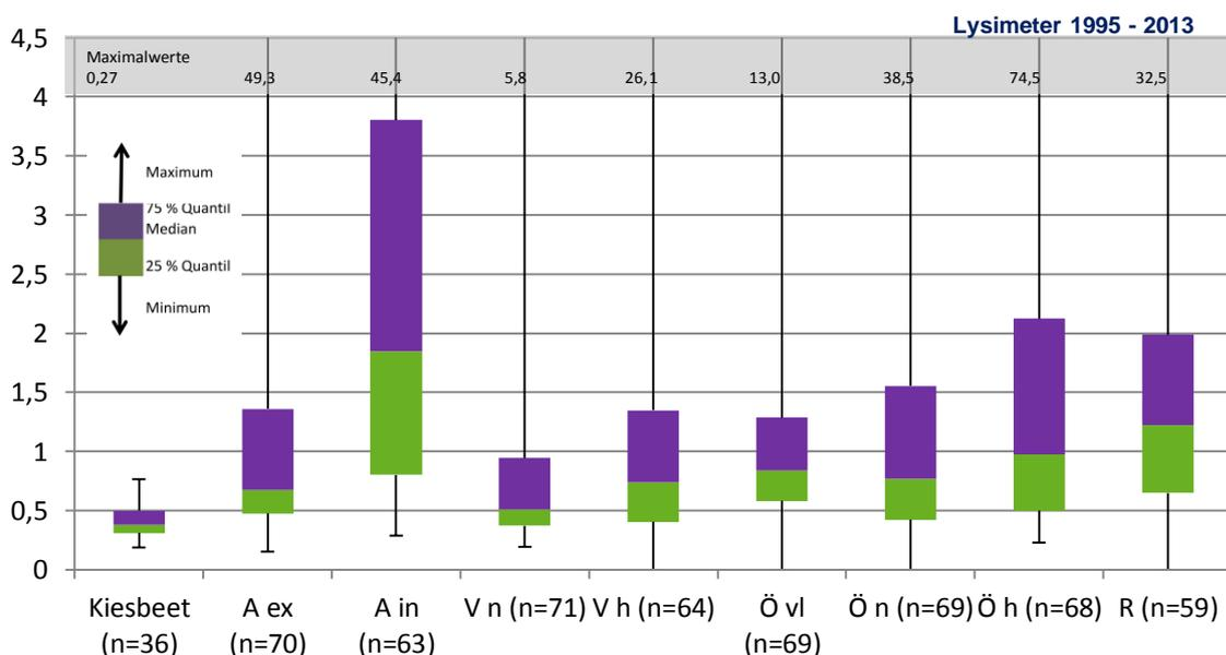
**Abbildung 7:** Rückgerechnete mittlere K-Konzentration (mg/l) im Sickerwasser aller Bewirtschaftungsvarianten nach 18 Versuchsjahren
