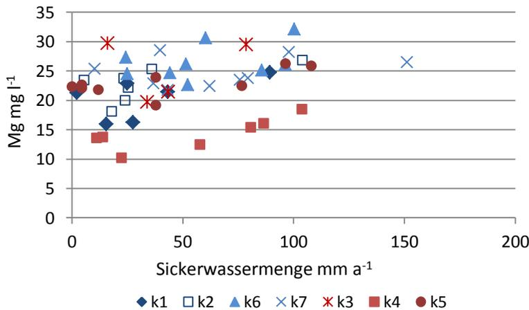
**Abbildung 17:** Zusammenhang zwischen den Jahresdurchschnittswerten der Mg-Konzentration des Sickerwassers und der Sickerwassermenge der Einzellysimeter auf der Para-Rendzina aus unterem Keuper im Untersuchungszeitraum von 2005 bis 2014 (mineralisch: k1, k2, k6 und k7 (blau), mineralisch-organisch: k3, k4 und k5 (rot))
