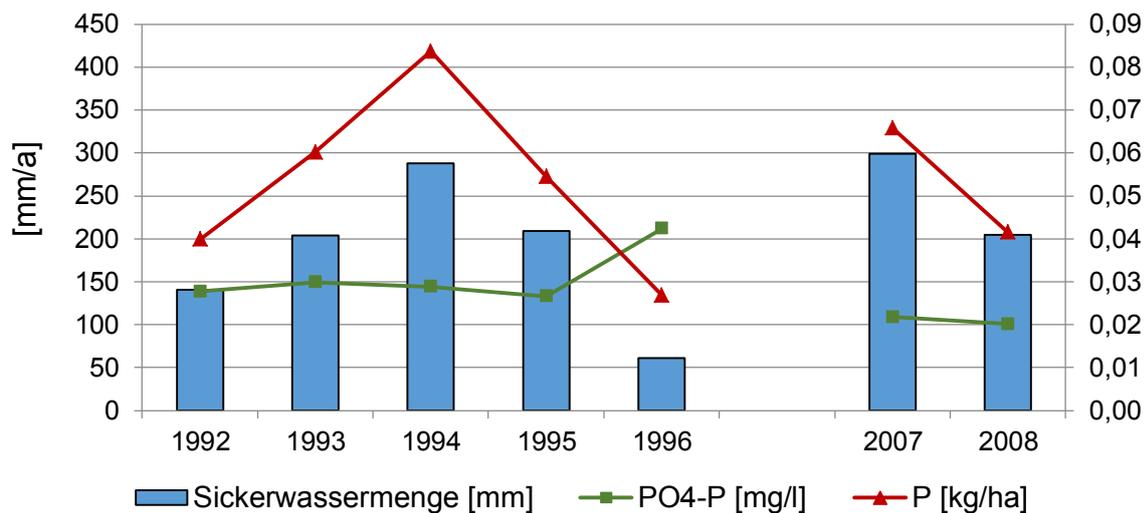
**Abbildung 10:** Sickerwassermenge, PO<sub>4</sub>-P-Konzentration und P-Austrag im Mittel der sechs Lysimeter
