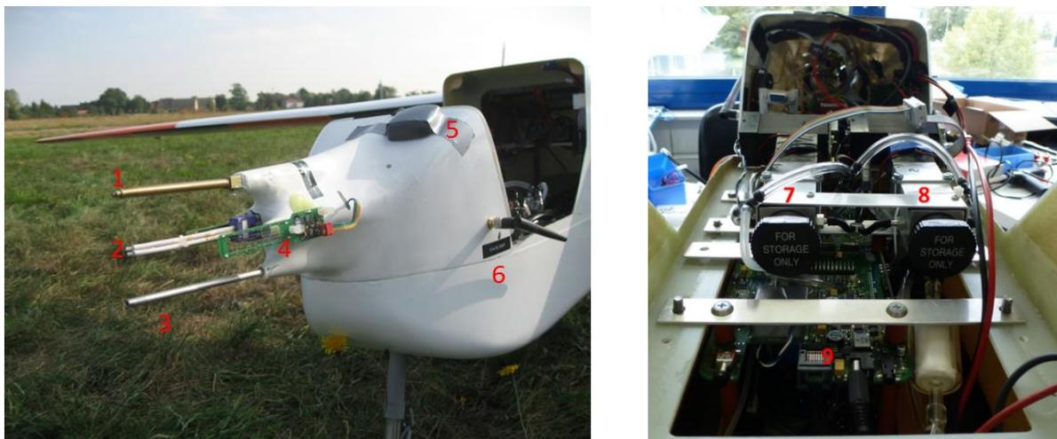
Abbildung 33: Linke Seite: Messgeräte an der Vorderseite des Flugzeuges: 1) Fünflochsonde, 2) Temperatursensor und Feuchtesensor P14 Rapid, 3) Aerosoleinlass, 4) Temperatursensor, 5) GPS Antenne, 6) Telemetrie Antenne. Rechte Seite: Aerosolmessgeräte im Inneren der Flugzeuges: 7,8) CPC1 und CPC2, 9) optischer Partikelzähler (OPC), zusätzlich wurde im hinteren Bereich das AE51 eingebaut.
