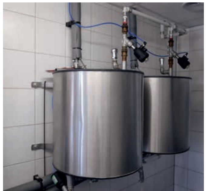
Abbildung 13: Milchvorkühler im Praxiseinsatz: Unter dem Edelstahlzylinder ist eine doppelwandige Rohrwendel untergebracht, die Milch fließt im Innenrohr.
