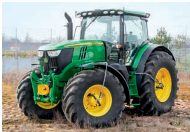
Abbildung 29: Traktor mit nachgerüsteter Reifendruckanlage
