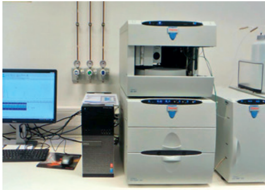
Abb. 13: Ionenchromatograph zur Bestimmung von Anionen und Kationen in Proben der Nassen Deposition
