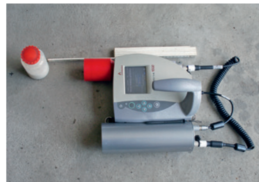
Abb. 4: Untersuchung eines Fundes radioaktiver Stoffe mit einem kombinierten Gammastrahlungs- und Neutronenmessgerät.
