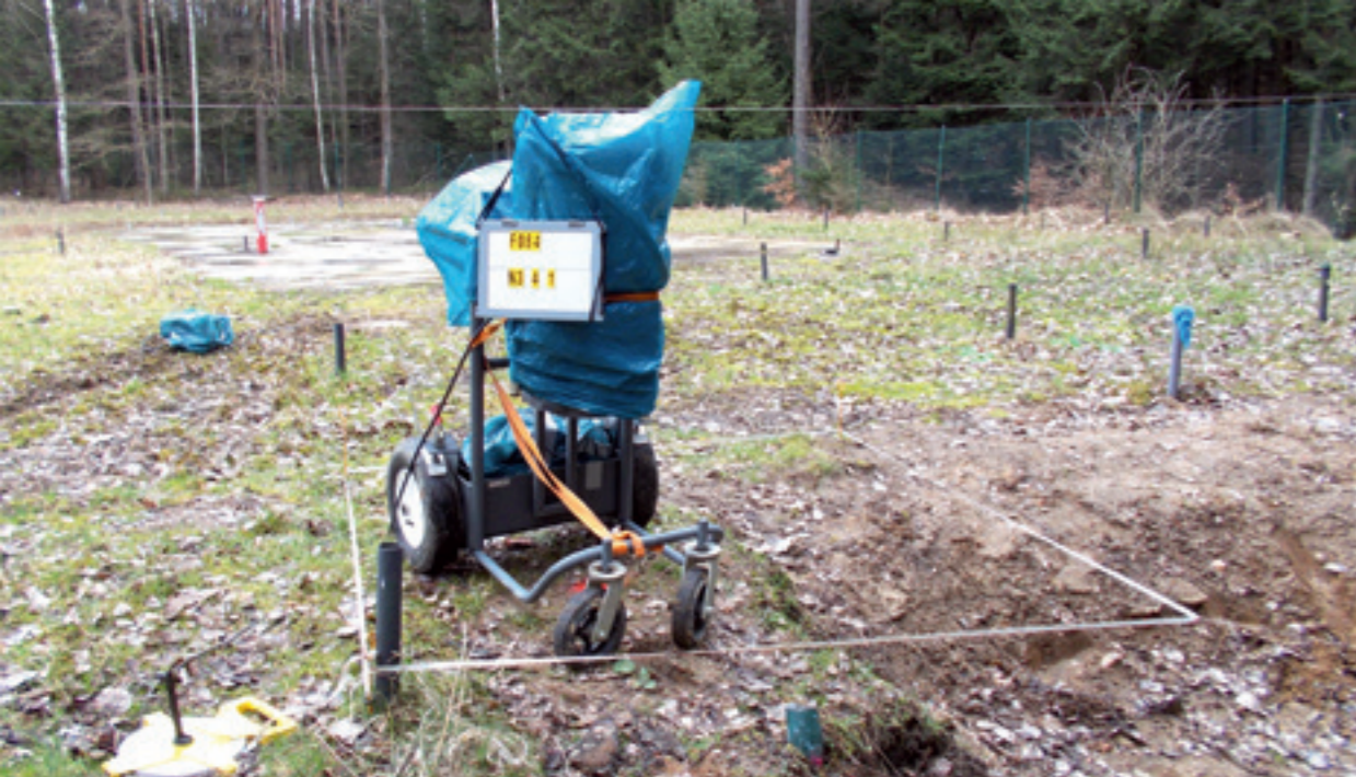
Abb. 1: In-situ-Gammaspektrometrie im Freigelände am Forschungsstandort Rossendorf.
