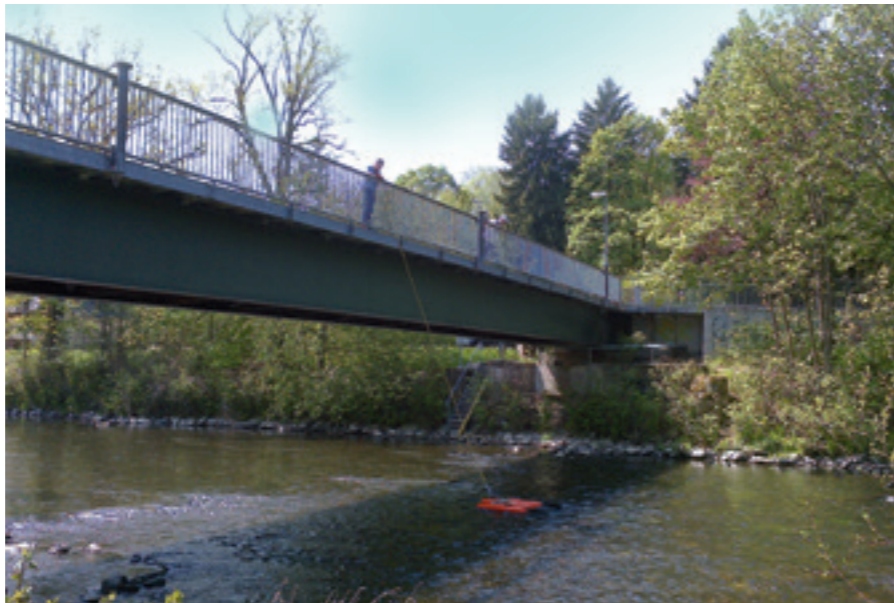
Abb. 1: ADCP-Messung am Pegel Aue (Flöha)
