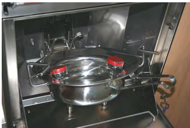
Abbildung 11: Überprüfung der thermischen Desinfektionsleistung eines Reinigungs- und Desinfektionsgerätes für Steckbecken mittels Temperaturdatenloggern
