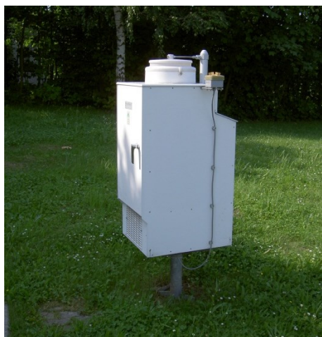
Abbildung 40: Eigenbrodt-Sammler zur Bestimmung der nassen Deposition
