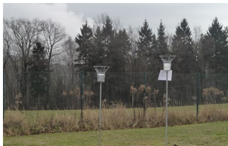
Abbildung 39: Probenahmegefäß für Staubniederschlagsmessungen (Bergerhoff-Sammler)
