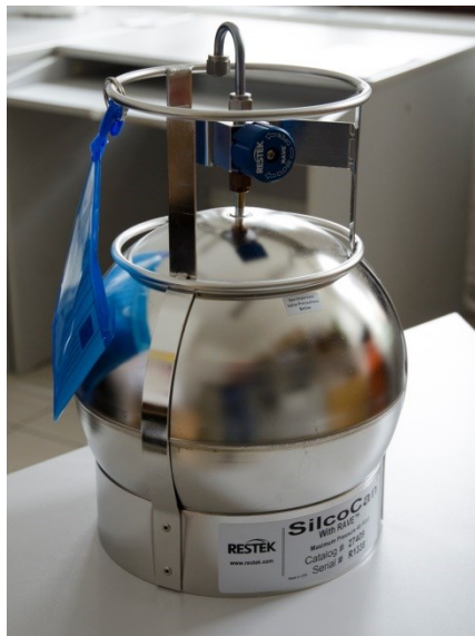
Abbildung 37: Probehälter, die im Projekt OdCom zur Aufnahme von Luftproben bei besonderen Geruchsereignissen eingesetzt werden. Foto: Gesundheitsamt Ústí nad Labem
