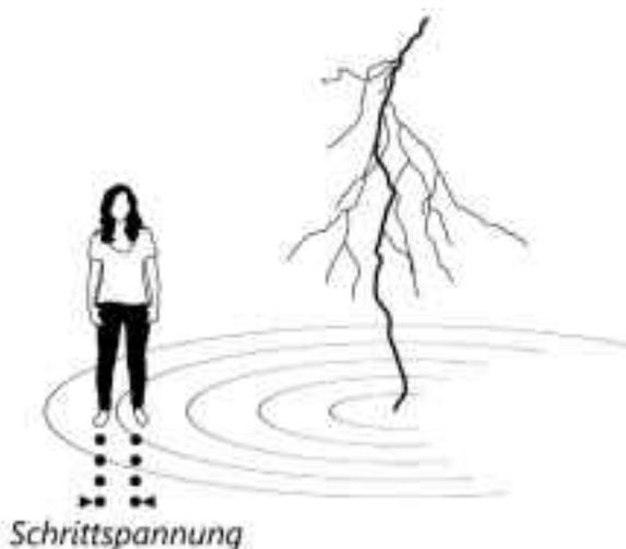
Eine Person nimmt mit den Beinen eine „Schritt“-Spannung auf – ein Teil des Blitzstroms fließt durch den Körper. Dies ist im Umkreis von einigen 10 m rund um den Eintritt des Blitzes in den Erdboden gefährlich!
