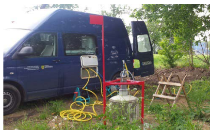
Abb. 7: Erstmalige Probenahme an einer neu errichteten Grundwassermess- stelle in Meißen-Bohnitzsch
