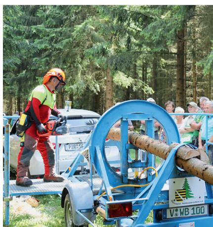
Falk Germann von der Maschinenstation Crottendorf demonstriert am Baumbiegesimulator mögliche Gefahren bei der Windwurfaufarbeitung; Foto: Bert Schmieder
