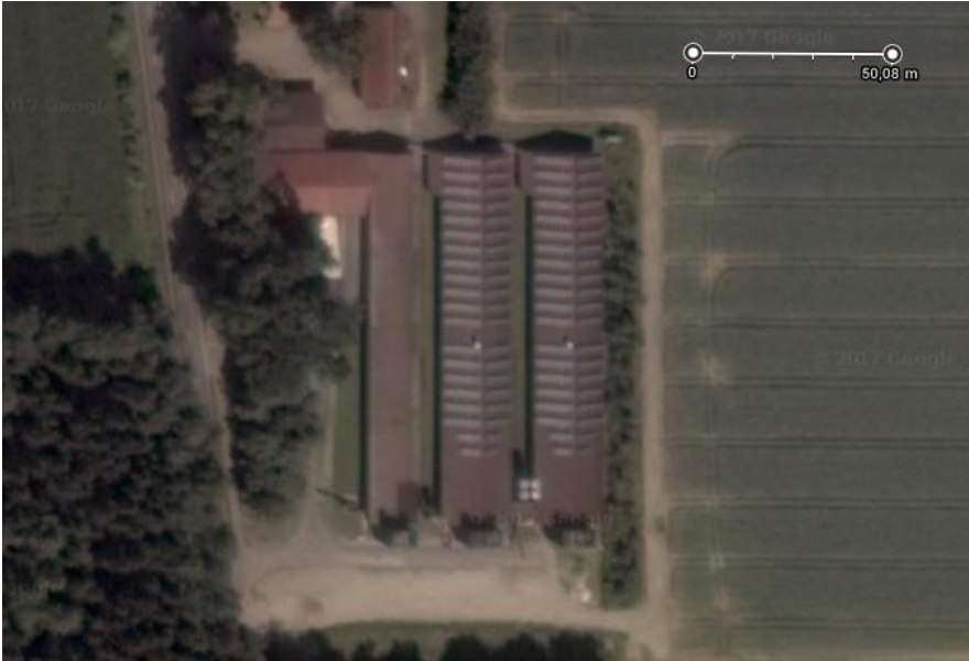
Abbildung 1: Aufsicht auf Legehennenstall 1 (LH1), gemessen wurde am Stallgebäude ganz rechts. Der 12 Meter hohe Abluftturm mit den Abluftkaminen ist an der südlichen Giebelwand positioniert.
