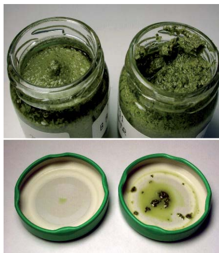
Abb. 2: Twist-off Verschlüsse für ölhaltige Lebensmittel führten 2010 erfreulicherweise nicht zu Weichmachermigrationen oberhalb der zulässigen Grenzwerte.
