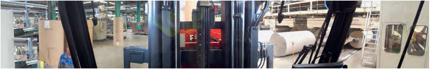
Sicht aus Fahrerkabine mit starker Sichteinschränkung durch Last und Kabinenrahmen
