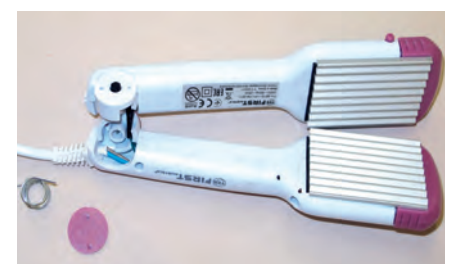
Abbildung 6: Mangelhafte Festigkeit der Konstruktion
