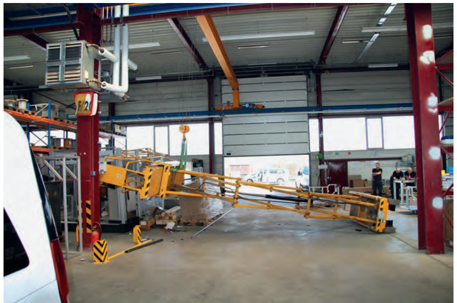
Unfallstelle: Fertigungshalle mit umgestürzter Scherenhebebühne
