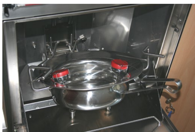
Abbildung 2: Überprüfung der thermischen Desinfektionsleistung eines Reinigungs- und Desinfektionsgeräts für Steckbecken mittels Temperatur-Datenloggern
