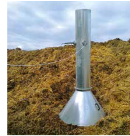
Abb. 11: Messung diffuser Emissionen an einem Misthaufen
