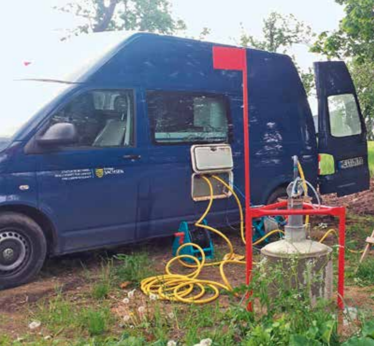
Abb. 9: Erstmalige Probenahme an einer neu errichteten Grundwassermessstelle in Meißen-Bohnitsch
