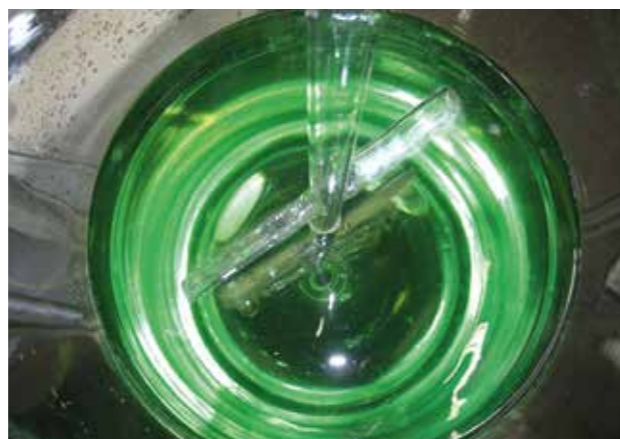
Abb. 21: Vorbereitung eines Ringversuchs Wasser – Blick ins Rührgefäß
