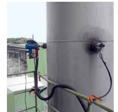
Abb. 13: Emissionsmessungen an einem Schornstein
