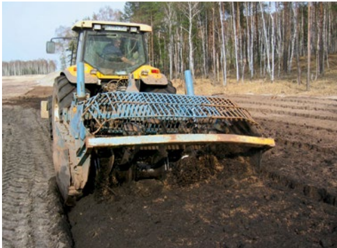
Tiefspatenfräse bei der Kalkeinarbeitung in ein stark kohle- und schwefelhaltiges Kippsubstrat
