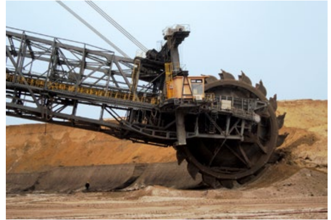
Schaufelradbagger im Abraumschnitt Tagebau Welzow-Süd, hier wird besonders »kulturfreundliches« Material gezielt gewonnen
