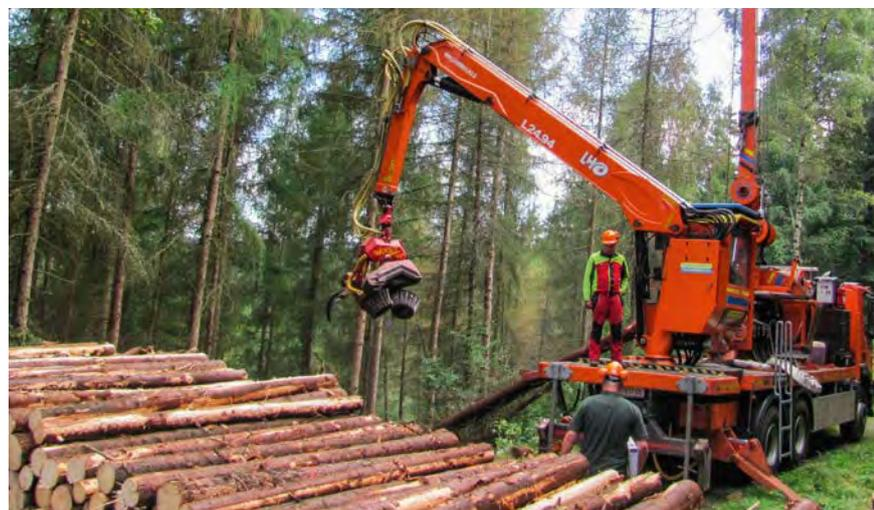
Bild 10.4: Seilkranbringung und Aufarbeitung mit Prozessor auf Maschinenweg am Steilhang
