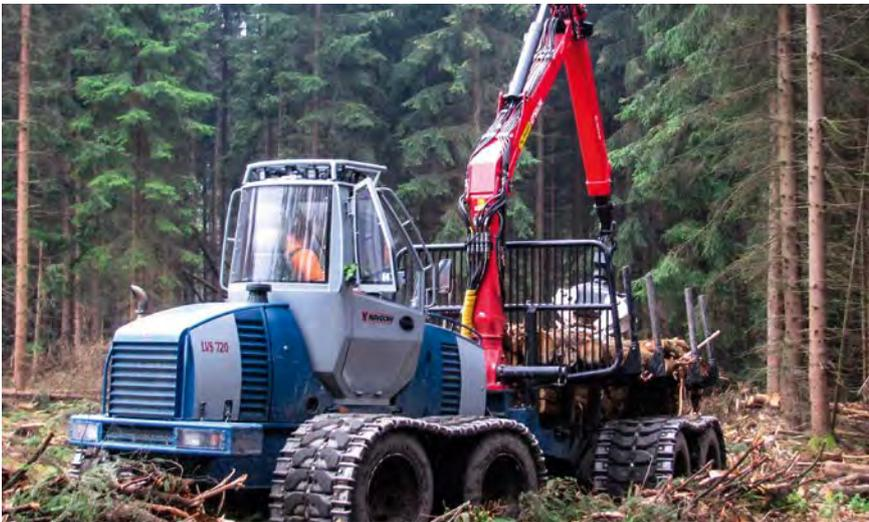
Bild 10.1: Kleiner Forwarder mit speziellen Moorbändern
