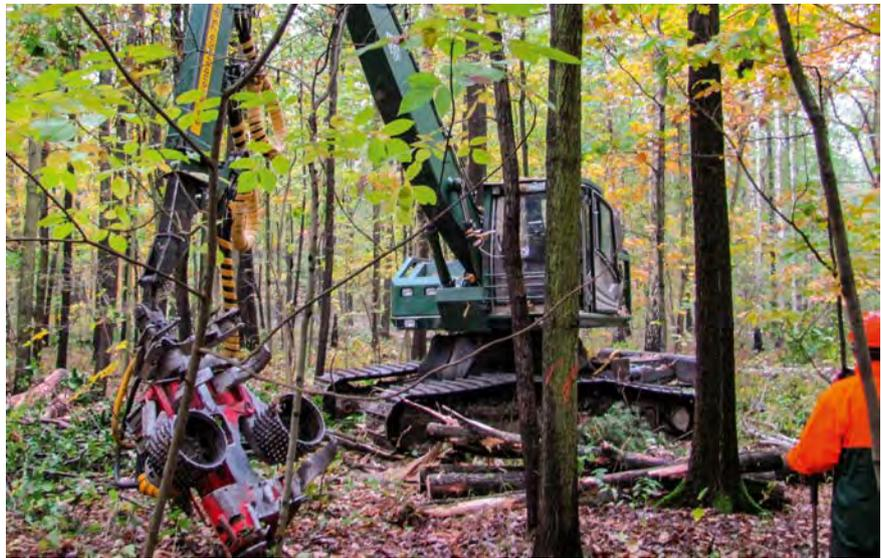
Bild 10.3: Harvester mit Raupenfahrwerk
