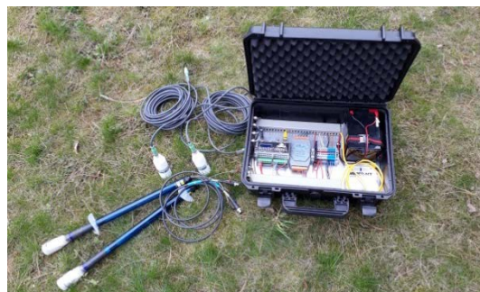
Abb. 11: Messkoffer zur Kalibrierung Tensiometer und TDR-Sonden
