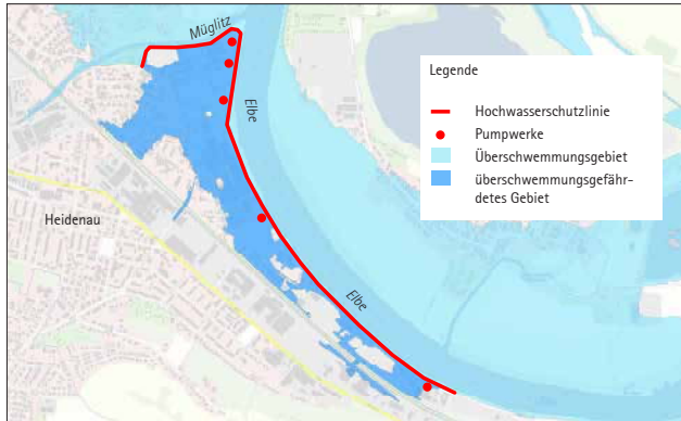
Verlauf der Hochwasserschutzlinie an der Elbe in Heidenau
