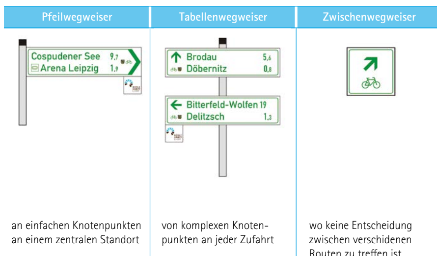
Abb. 12.1 Grundelemente der Radverkehrswegweisung in Sachsen
