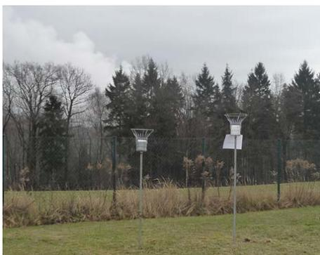
**Abbildung 38: Probenahmegefäß für Staubniederschlagsmessungen (Bergerhoff-Sammler)**
