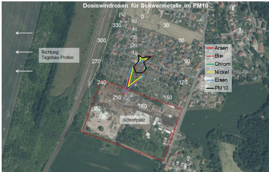
**Abbildung 41: Lageplan des Messortes zu den Emissionsquellen mit windrichtungsabhängigen Dosen von Feinstaub PM<sub>10</sub> und einigen ausgewählten Inhaltsstoffen**
