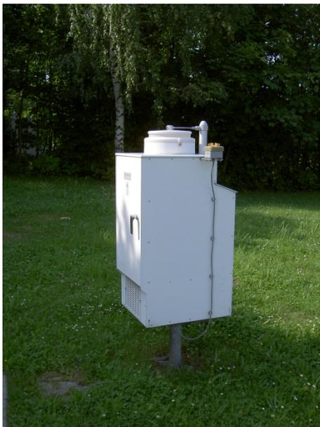
**Abbildung 39: Eigenbrodt-Sammler zur Bestimmung der nassen Deposition**
