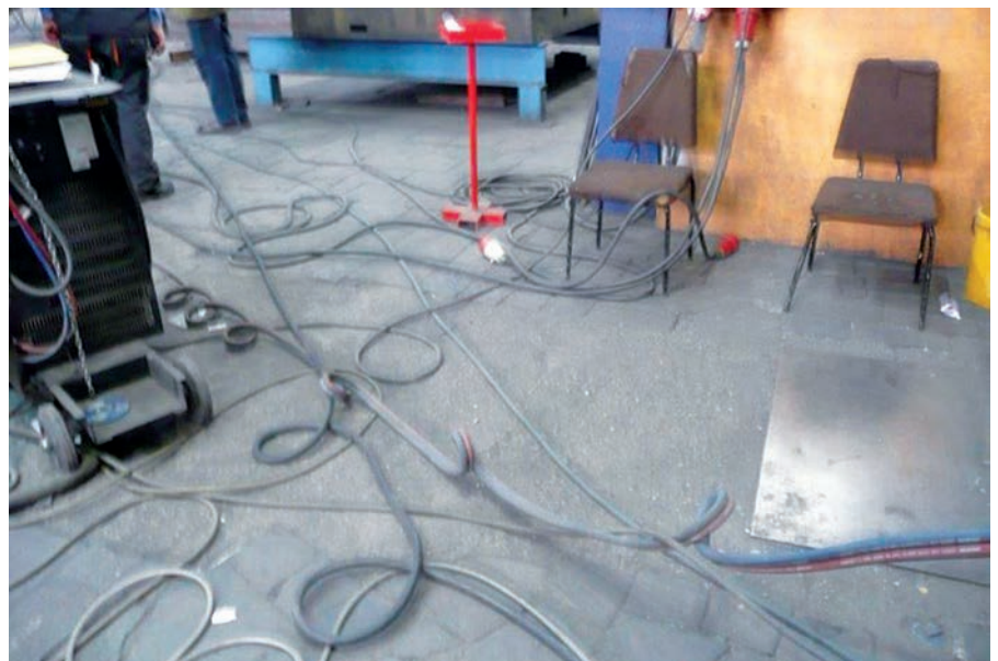
Stolper- und Sturzfallen im Werkstattbereich durch Kabel und Schläuche
