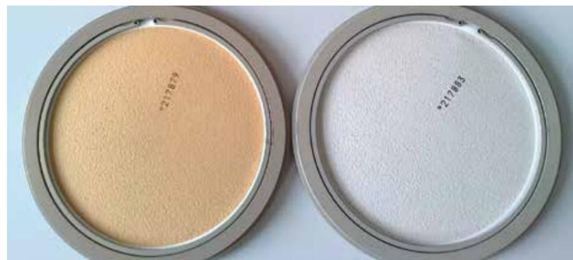
Abb. 9: Optische Befunde: Filter links – bei südlicher Anströmrichtung aus Richtung Schrottplatz, im Vergleich dazu Filter rechts – sonntags, bei drehenden Winden
