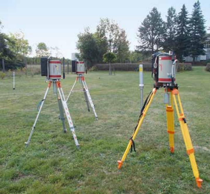
Abb. 1: In-situ-gammaspektrometrische Vergleichsmessung mit dem Bundesamt für Strahlenschutz
