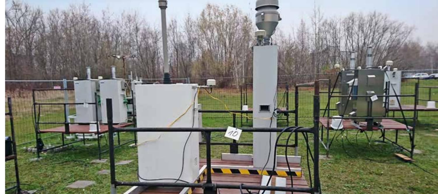
Abb. 10: Staubsammler beim Ringversuch in Polen zusammen mit Sammlern der natürlichen, staatlichen Messnetzbetriebe unter der Leitung des Główny Inspektorat Ochrony Środowiska (GIOŚ)
