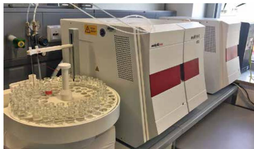
Abb. 8: TOC/TNb-Analysator
