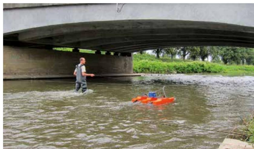
Abb. 3: Messtechniker mit ADCP-Messboot am Pegel Zittau 1
