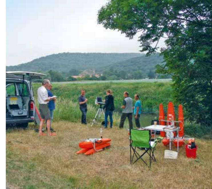
Abb. 13: ADCP-Vergleichsmessung mit mehreren Bundesländern in Thüringen
